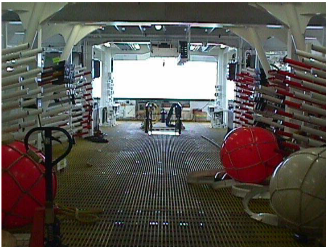
Figura 3-13: poppa di una nave per ricerca geofisica con gli stabilizzatori di profondità e le boe (Fonte: eni s.p.a. divisione e&p)
