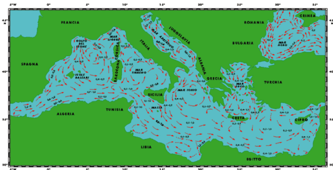
Figura 4-7: schema della circolazione delle acque superficiali del Mediterraneo (Fonte: Istituto Idrografico della Marina)
