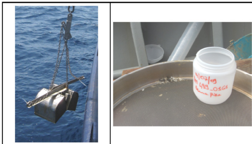
Figura 4-28: benna Van Veen (sinistra) e operazioni di setacciatura (destra) (Fonte: “AM 499 Report Ambientale pozzo Atlas1”, 2009)
