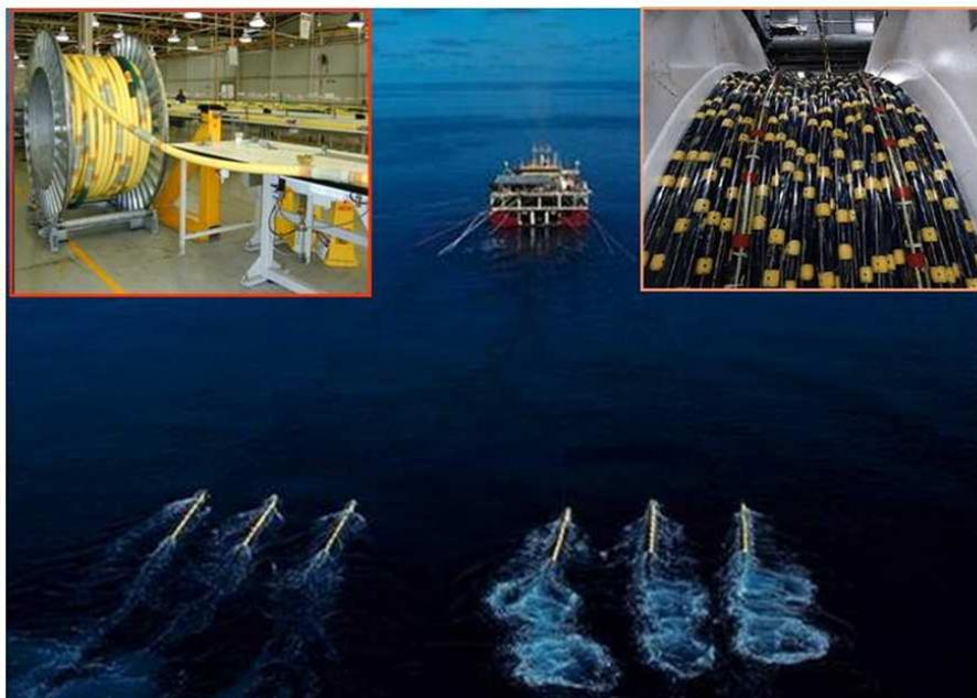
**Figura 3-5: esempio di campagna sismica a mare 3D (Fonte: eni s.p.a. divisione e&p)**
