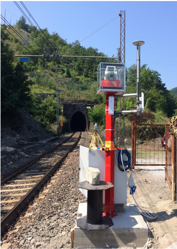
Figura 11 –Stazione di monitoraggio con teodolite robotizzato
