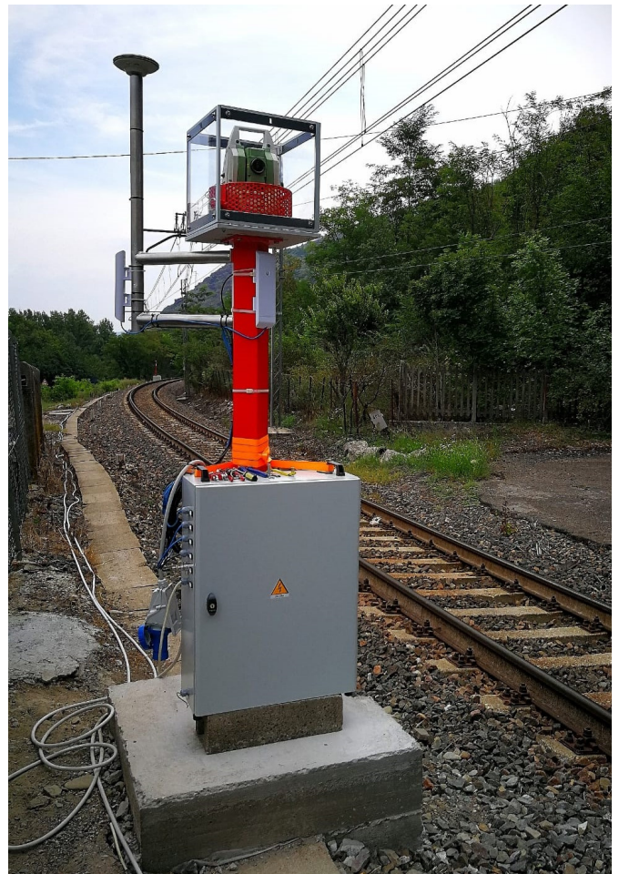
Figura 11 –Stazione di monitoraggio con teodolite robotizzato
