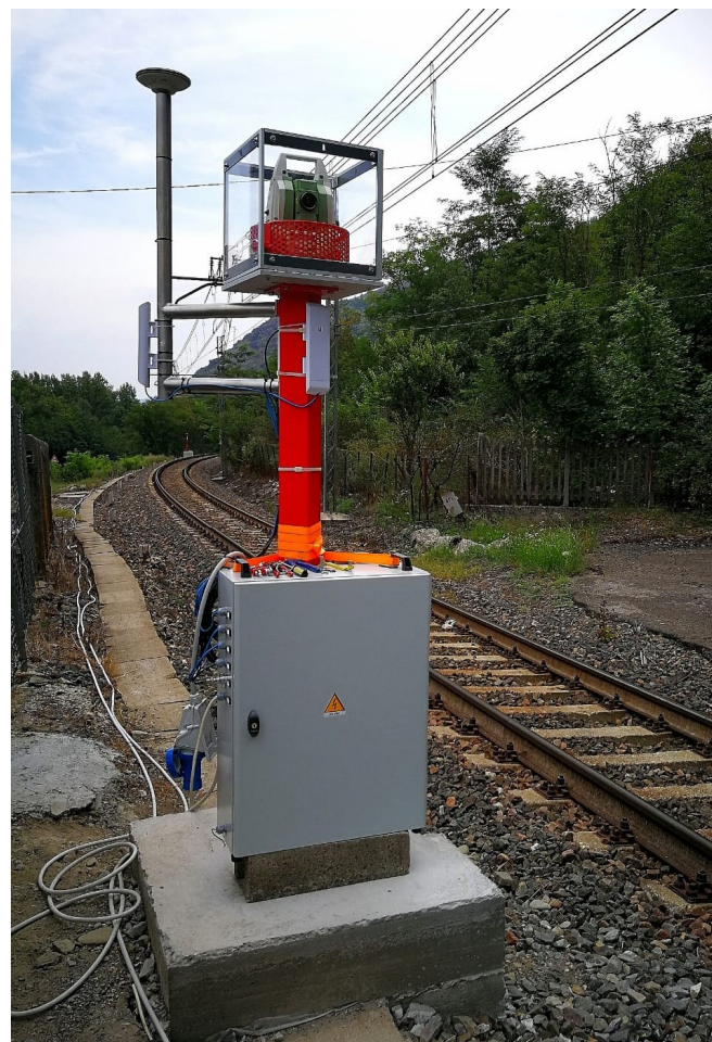
Figura 3 –Stazione di monitoraggio con teodolite robotizzato
