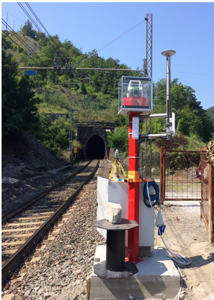
Figura 3 –Stazione di monitoraggio con teodolite robotizzato
