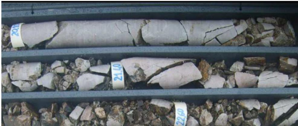
**Figura 11 – Cassa n°5 (20-25 m), sondaggio S5. Trovante lapideo compatto con caratteristiche identiche a quelle del sottostante substrato quarzítico Verrucano**
