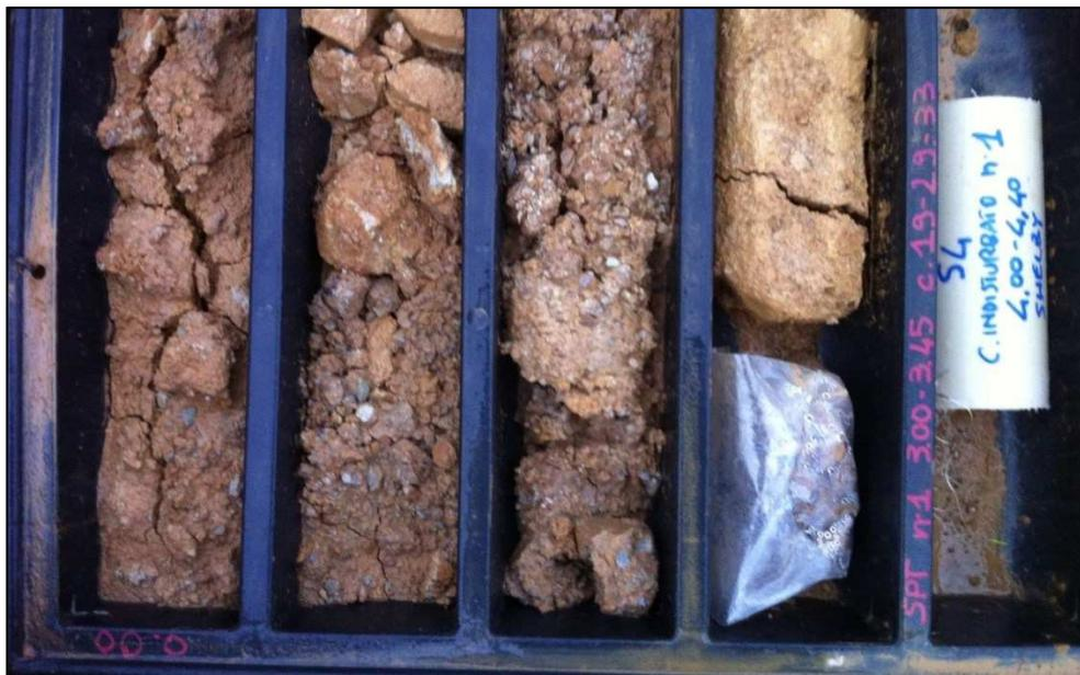
Figura 8 – Particolare della cassetta n°1 (0-5 m) del sondaggio S4 in cui sono visibili le caratteristiche granulometrico-tessiturali dell'Unità V1
