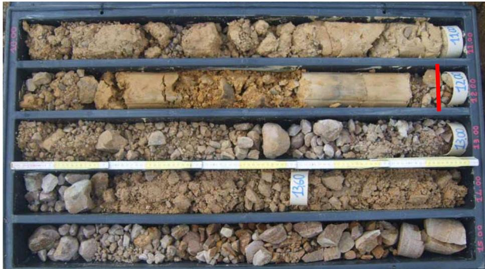
**Figura 10. Cassetta n°3 (10-15 m) del sondaggio S4. Passaggio da unità V2 a unità V3a (11,9 m) con chiaro aumento della componente ghiaiosa e diminuzione della matrice più fine.**
