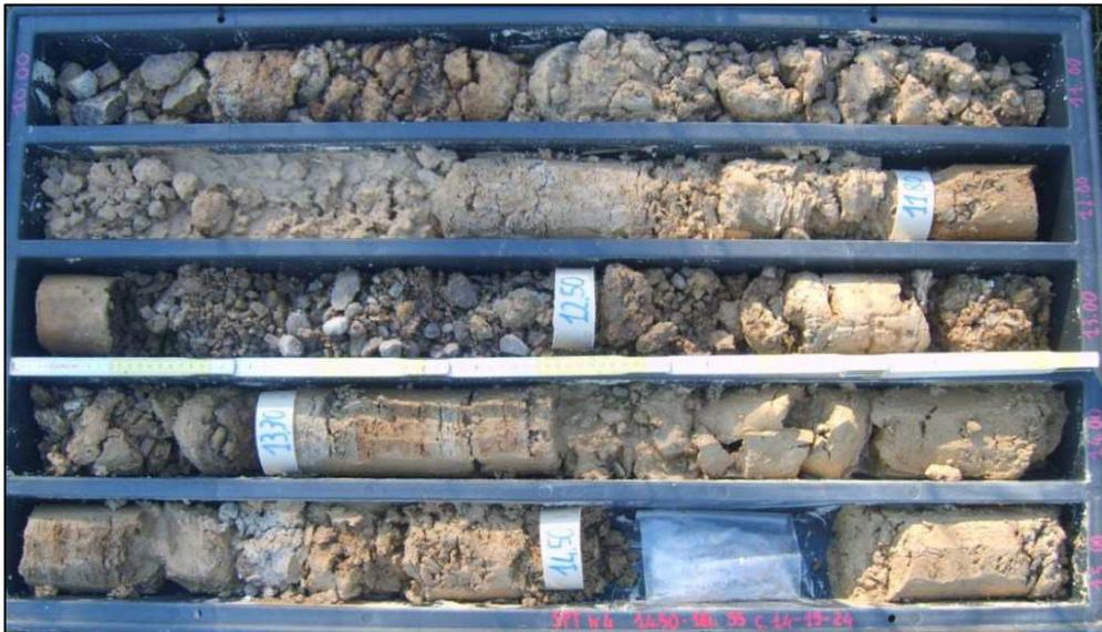
**Figura 9 – Cassette n°3 (10-15 m) del sondaggio S1 in cui si presenta l'unità V2**
