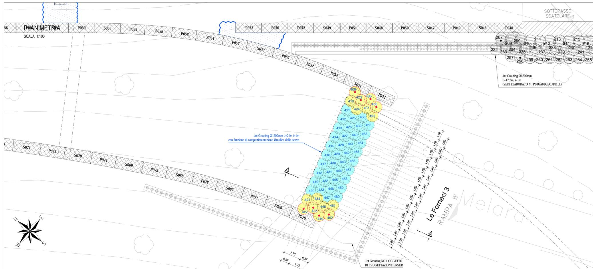
SCHEMA PLANIMETRICO TRATTAMENTI IN JET GROUTING
