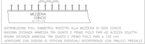
DISTRIBUZIONE PIOLI SIMMETRICI RISPETTO ALLA MEZZERIA DI OGNI CONCIO MASSIMA DISTANZA AMMESSA TRA GIUNTO E PRIMO PILO PARI AD ALTEZZA SOLETTA MINIMA DISTANZA AMMESSA TRA GIUNTO E PRIMO PILO PARI A 100 mm VERIFICARE CON DISEGNI DI OFFICINA EVENTUALI INTERFERENZE CON TRALICCI PREDALLE
