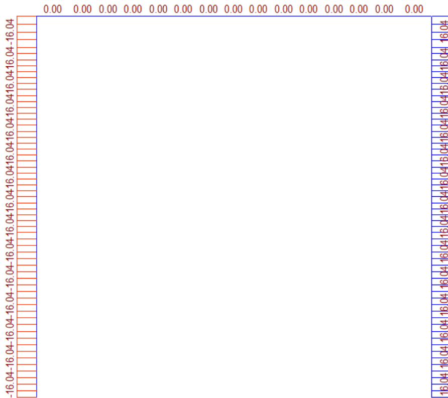
Figura 27 – Variazione termica uniforme +15°C – Forze di taglio
