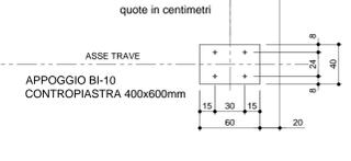
SEZIONE TRASVERSALE IN ASSE APPOGGIO
