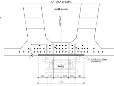
SEZIONE TRASVERSALE IN ASSE APPOGGIO
