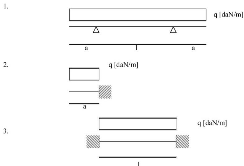
In quanto per le caratteristiche geometriche del pannello è sempre  $a > l/2$  lo schema di carico più gravoso si ha per la condizione 2, per cui nel calcolo si adotta lo schema di
