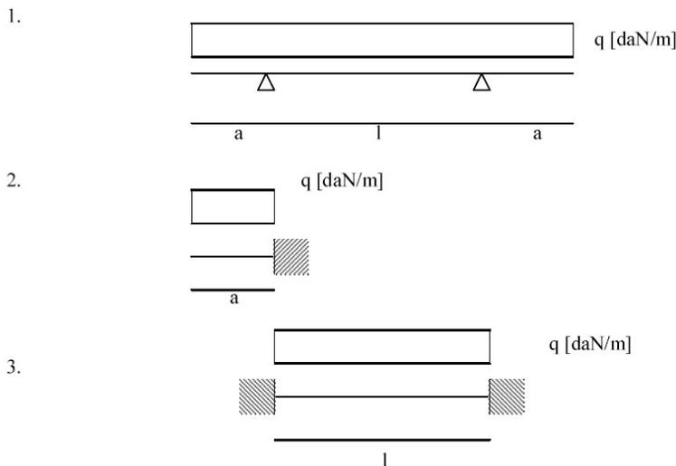
In quanto per le caratteristiche geometriche del pannello è sempre  $a > l/2$  lo schema di carico più gravoso si ha per la condizione 2, per cui nel calcolo si adotta lo schema di mensola incastrata nella nervatura.
