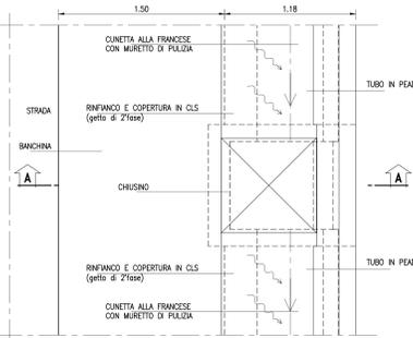
SEZIONE IN RILEVATO CON CUNETTA ASOLATA E COLLETTORE DI COLLEGAMENTO TRA LE GALLERIE FELETTINO II E FELETTINO III
