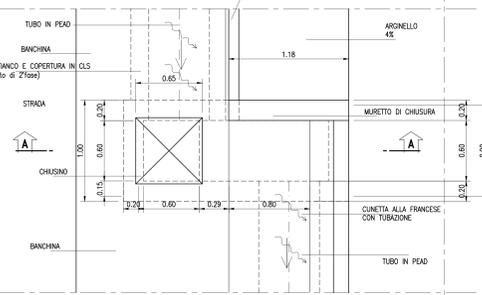
SEZIONE IN RILEVATO CON CUNETTA E COLLETTORE DI DRENAGGIO PIATTAFORMA
