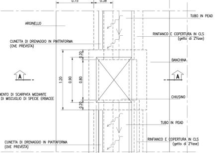
ELEMENTO DI MARGINE IN CORRISPONDENZA DEL MURO ESISTENTE
