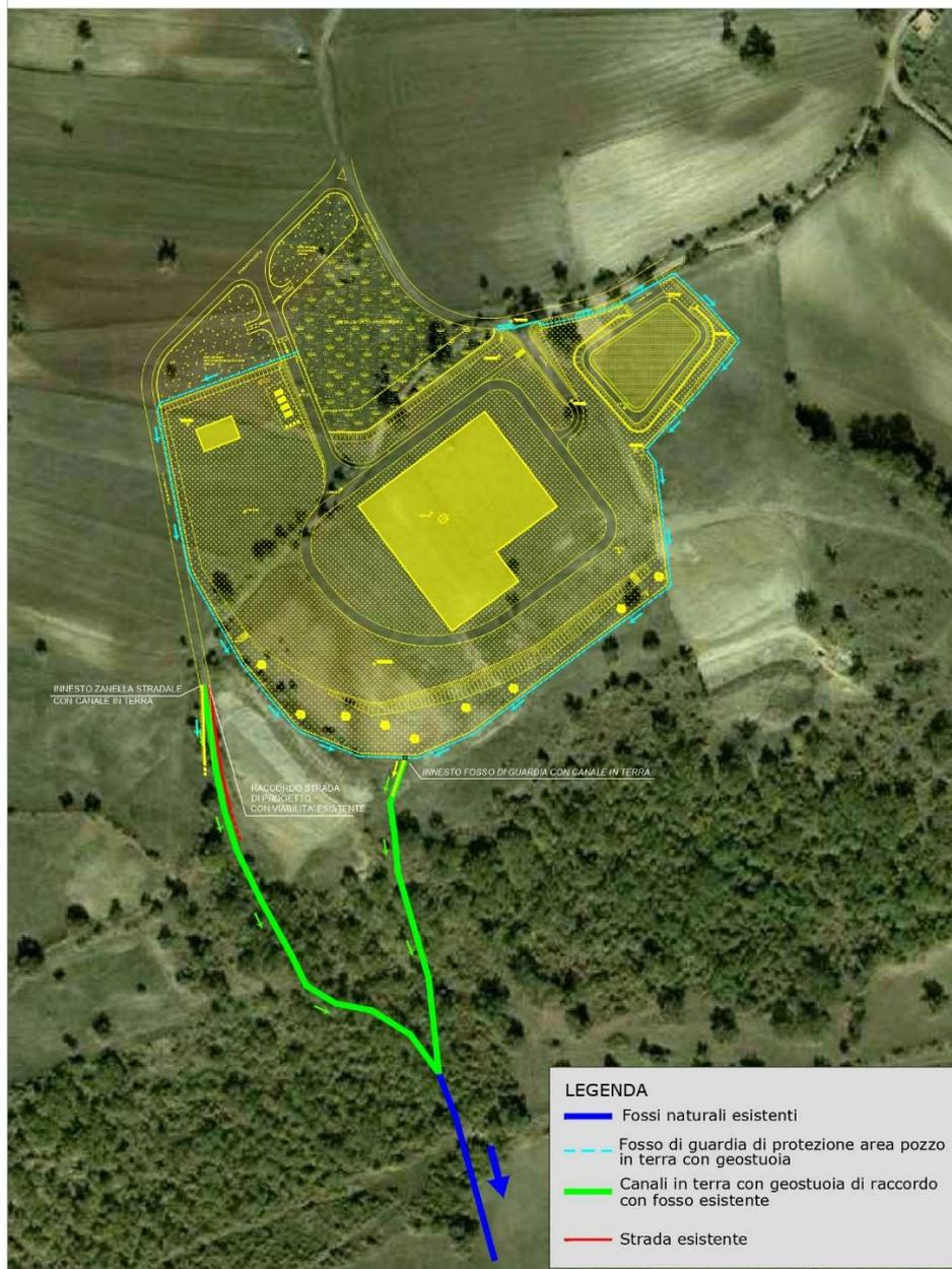
Figura12: Schema sintetico del progetto per la raccolta acque meteoriche relative all'area pozzo
