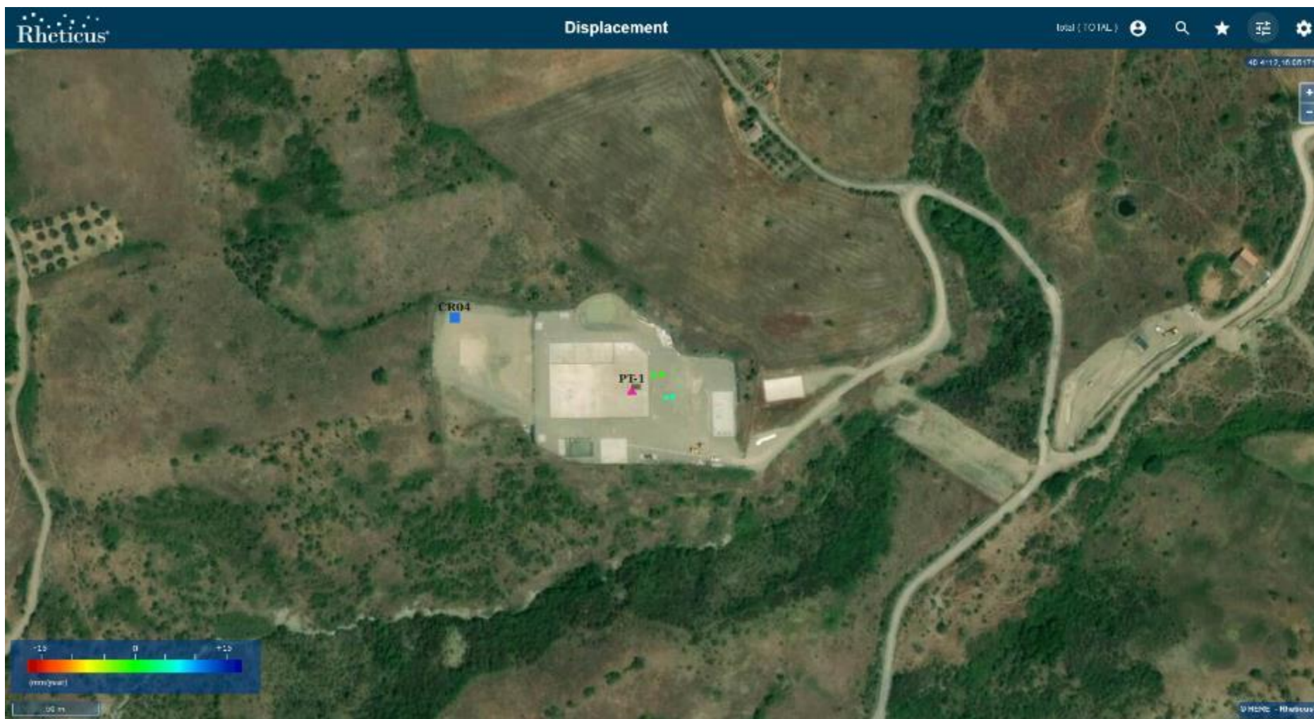
Figura 21: Pozzo PT-1 (indicato dal triangolo fucsia) caratterizzato da una discreta copertura di PS e dai quali nel periodo esteso a Dicembre 2019, non si evincono variazioni significative di velocità media rispetto al precedente rapporto [RD6]
