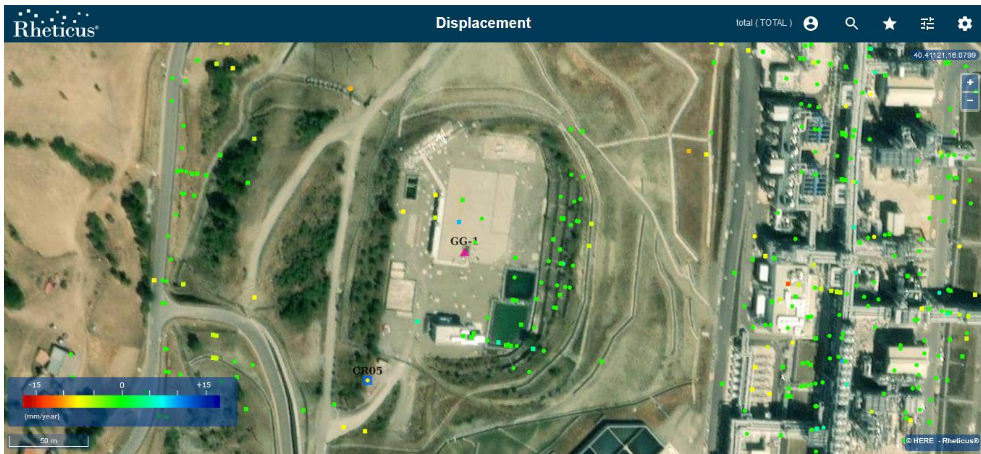
Figura 12: Pozzo GG-1 (indicato dal triangolo fucsia) caratterizzato da una buona copertura di PS e dai quali, nel periodo esteso a Giugno 2020, non si evincono variazioni significative di velocità media rispetto al precedente rapporto [RD8].
