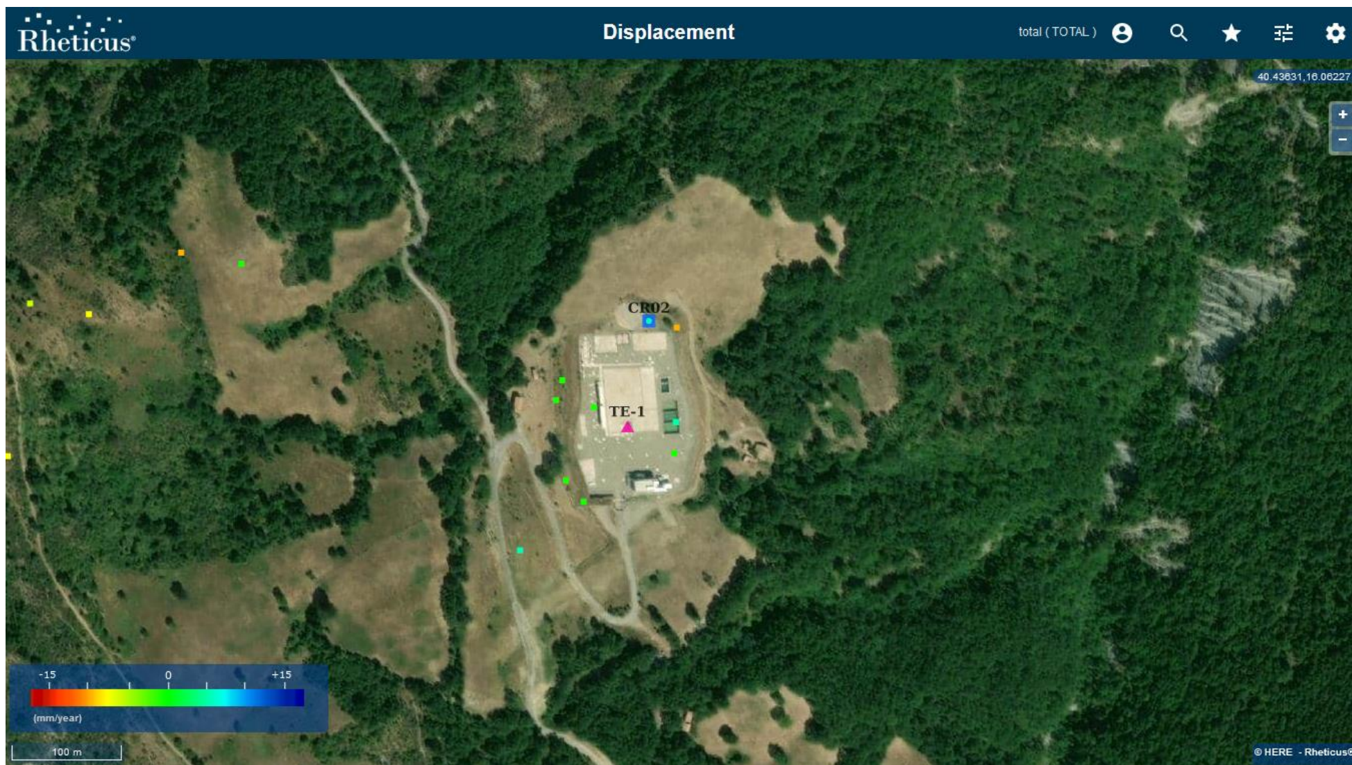
Figura 18: Pozzo TE-1 (indicato dal triangolo fucsia) caratterizzato da una buona copertura di PS e dai quali nel periodo esteso a Giugno 2020, non si evincono variazioni significative di velocità media rispetto al precedente rapporto [RD8].
