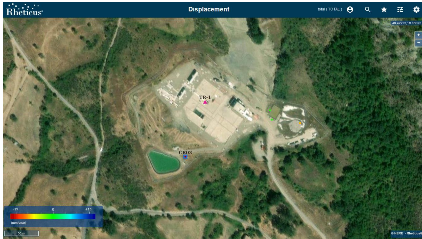
Figura 24: Pozzo TR-1 (indicato dal triangolo fucsia) sulla cui piazzola solo stati individuati 2 PS dai quali, nel periodo esteso a Giugno 2020, non si evincono variazioni significative di velocità media rispetto al precedente rapporto [RD8]. Dai PS verdi si evince come la parte est della piazzola non è influenzata dal fenomeno franoso situato a monte della stessa.
