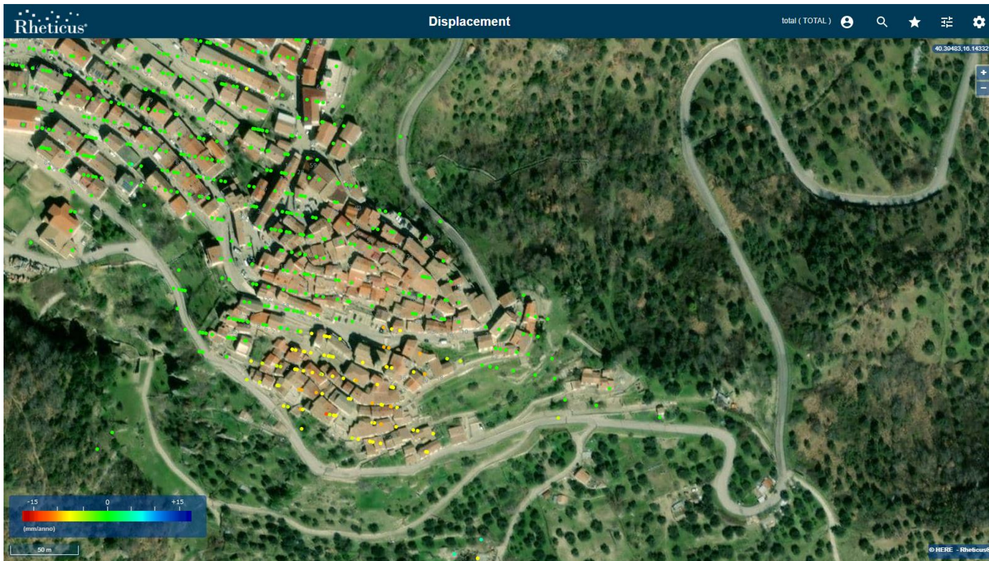
Figura 8: Serie temporale del PS (evidenziato dal puntatore blu nell'immagine) ad alta coerenza (0.9) situato al centro dell'area in movimento del centro abitato di Gorgoglione . La velocità media del PS sul periodo esteso a Dicembre 2020 è pari a -5.2 mm/anno in linea con quanto misurato nel precedente rapporto [RD9].
