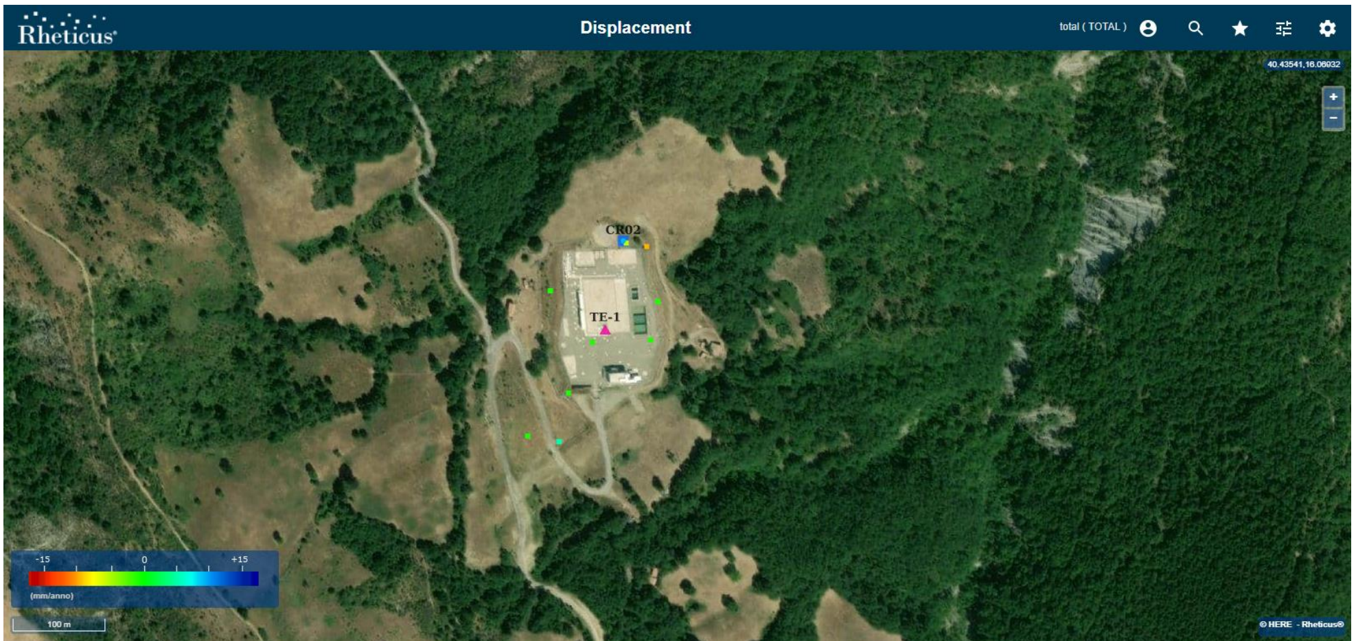
Figura 18: Pozzo TE-1 (indicato dal triangolo fucsia) caratterizzato da una buona copertura di PS e dai quali nel periodo esteso a Giugno 2021, non si evincono variazioni significative di velocità media rispetto al precedente rapporto [RD10].
