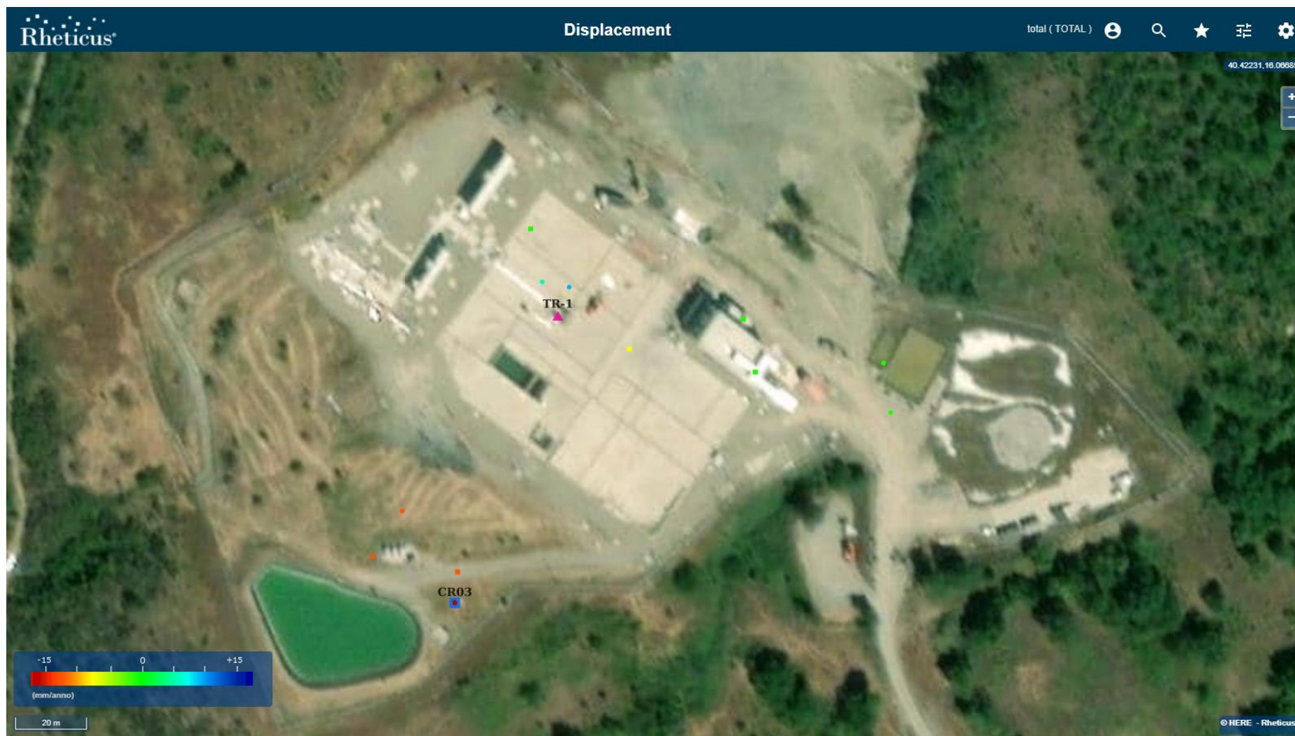
Figura 24: Pozzo TR-1 (indicato dal triangolo fucsia) Nel periodo esteso a Dicembre 2020, non si evincono variazioni significative di velocità media rispetto al precedente rapporto [RD9]. Dai PS verdi presenti si evince come la parte est della piazzola non è influenzata dal fenomeno franoso situato a monte della stessa.
