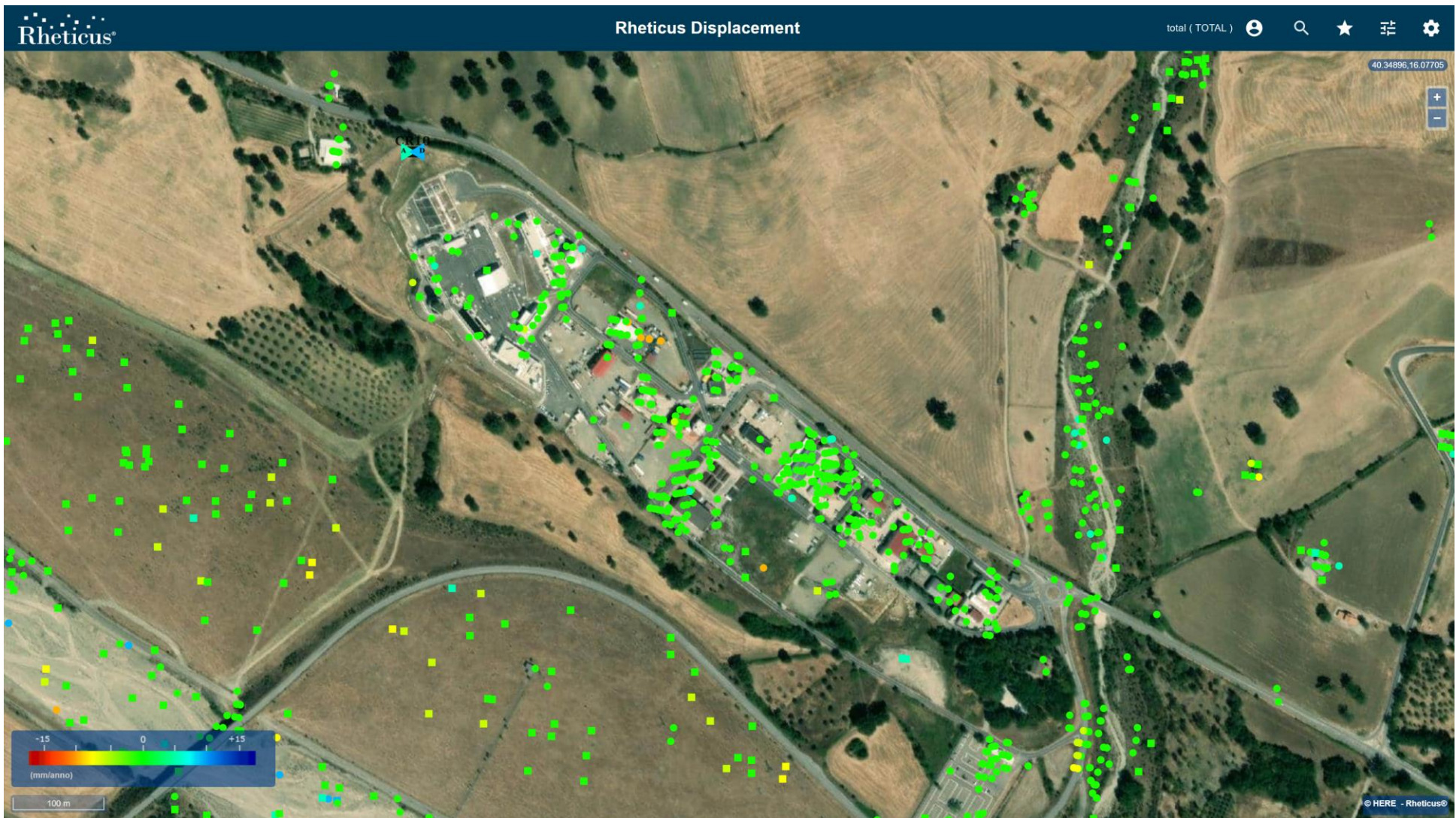
Figura 30: LPG Center caratterizzato da una buona copertura di PS e dai quali nel periodo esteso a Giugno 2021, non si evincono variazioni significative di velocità media rispetto al precedente rapporto [RD10].
