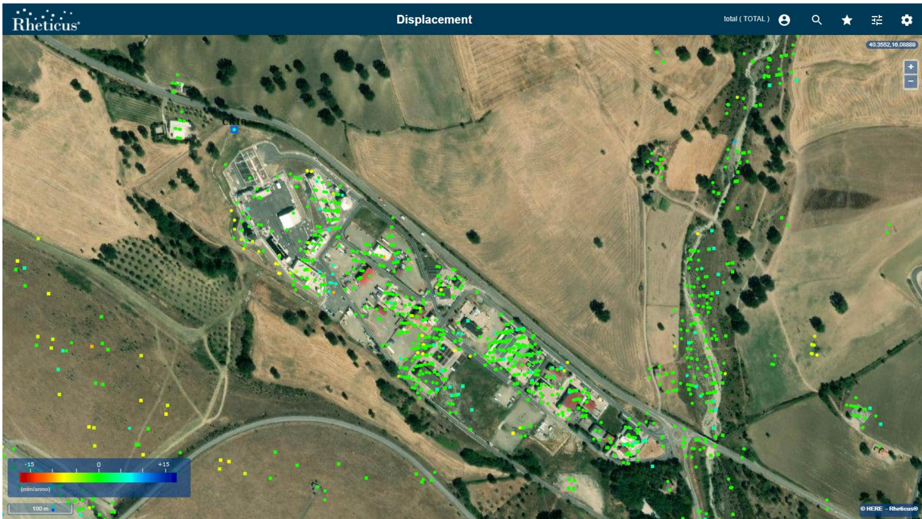
Figura 30: LPG Center caratterizzato da una buona copertura di PS e dai quali nel periodo esteso a Dicembre 2020, non si evincono variazioni significative di velocità media rispetto al precedente rapporto [RD9].
