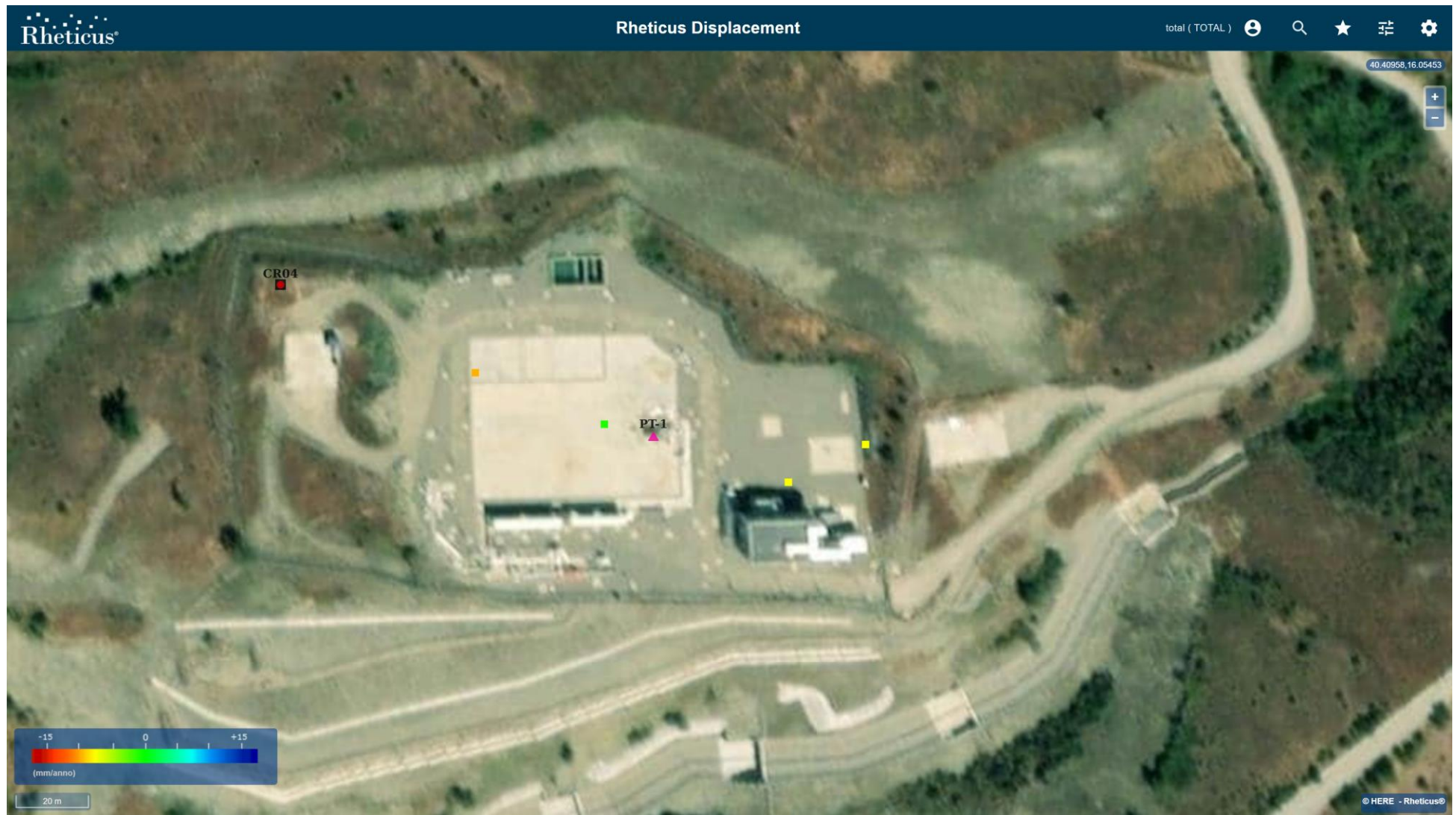
Figura 21: Pozzo PT-1 (indicato dal triangolo fucsia) Nel periodo esteso a Giugno 2021, non si evincono variazioni significative di velocità media rispetto al precedente rapporto [RD10][RD9].
