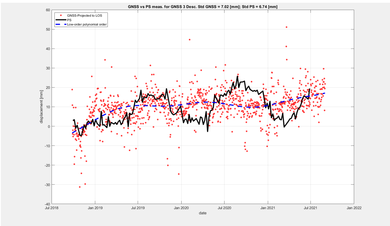
Figura 50: la figura rappresenta il confronto quantitativo effettuato in geometria SAR Descending tra le misure GNSS (punti rossi) e SAR (linea nera) in corrispondenza del CR06. La linea blu tratteggiata rappresenta il fit polinomiale stimato sui dati GNSS. Il trend delle serie temporali GNSS e SAR e le relative deviazioni standard confermano un ottimo accordo anche a livello quantitativo.
