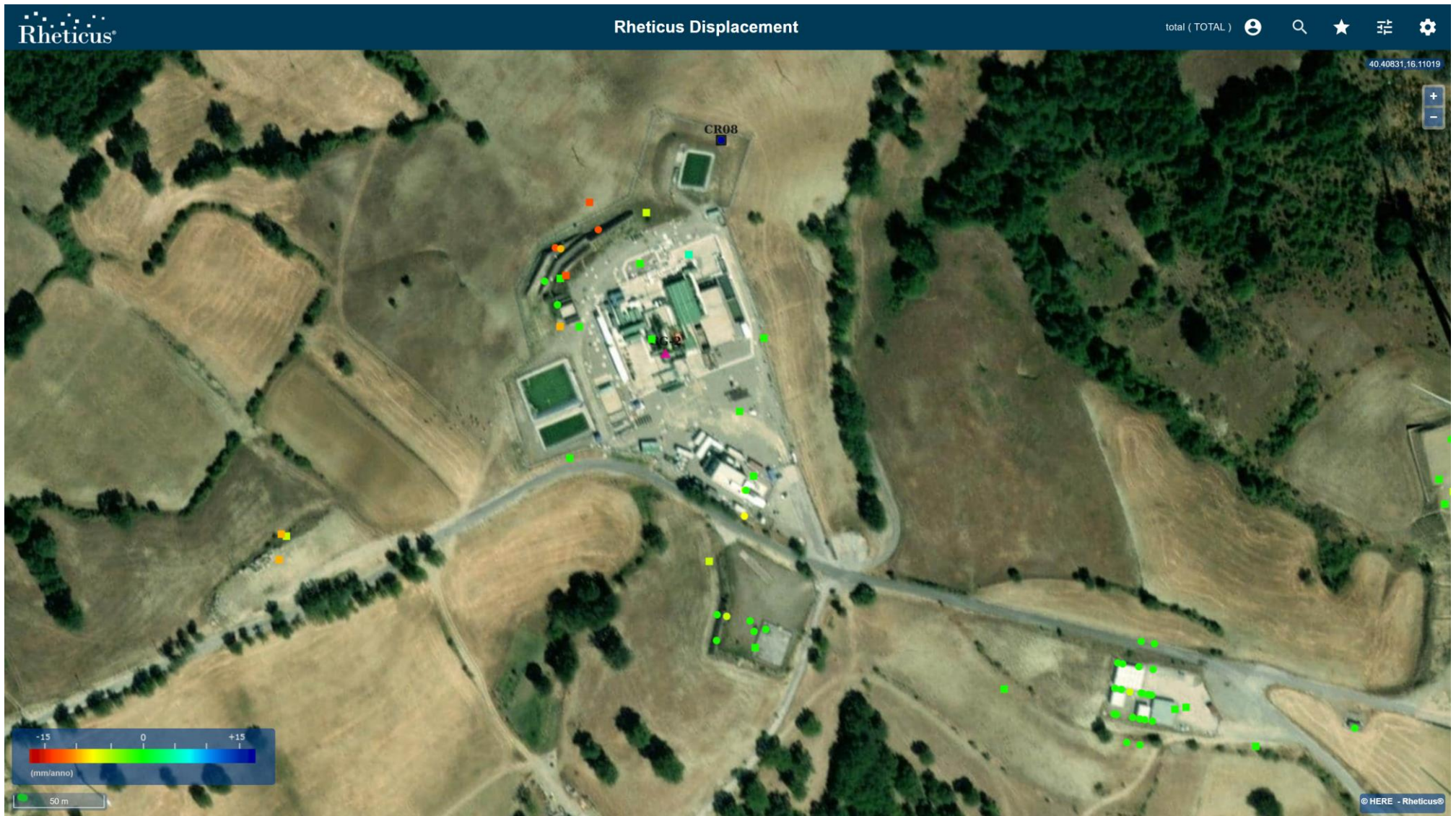
Figura 15: Pozzo GG-2 (indicato dal triangolo fucsia) caratterizzato da una buona copertura di PS e dai quali, nel periodo esteso a Giugno 2021, non si evincono variazioni significative di velocità media rispetto al precedente rapporto [RD10].
