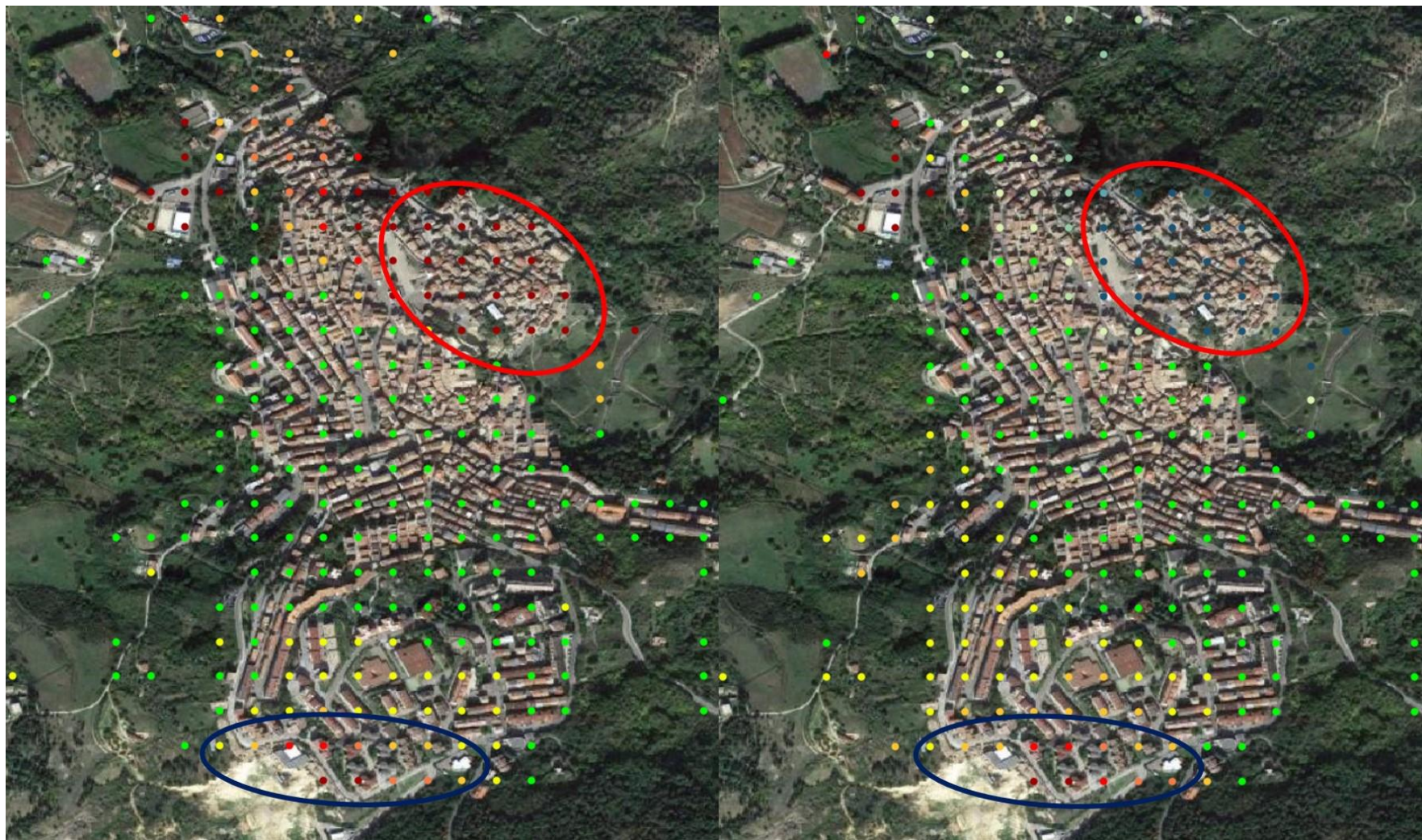
Figura 11: La mappa delle componenti di velocità media Est(+) –Ovest(-) (immagine di sinistra) e Verticale (immagine di destra) sul centro abitato di Stigliano calcolata sul periodo esteso a Giugno 2021 è in linea con quanto misurato nel rapporto precedente [RD10]. Sulla zona nord (evidenziata dal poligono rosso nelle immagini) si evince una velocità media in direzione Est pari a 23 mm/anno e una componente di abbassamento verticale medio pari a -17.4 mm/anno mentre la zona sud-ovest (evidenziata dal poligono blu nelle immagini) presenta uno spostamento medio in direzione Ovest pari a -7.9 mm/anno fino ad un massimo di -17.4 mm/anno e una componente di abbassamento verticale media pari a -7.4 mm/anno fino ad un massimo di -17.9 mm/anno.
