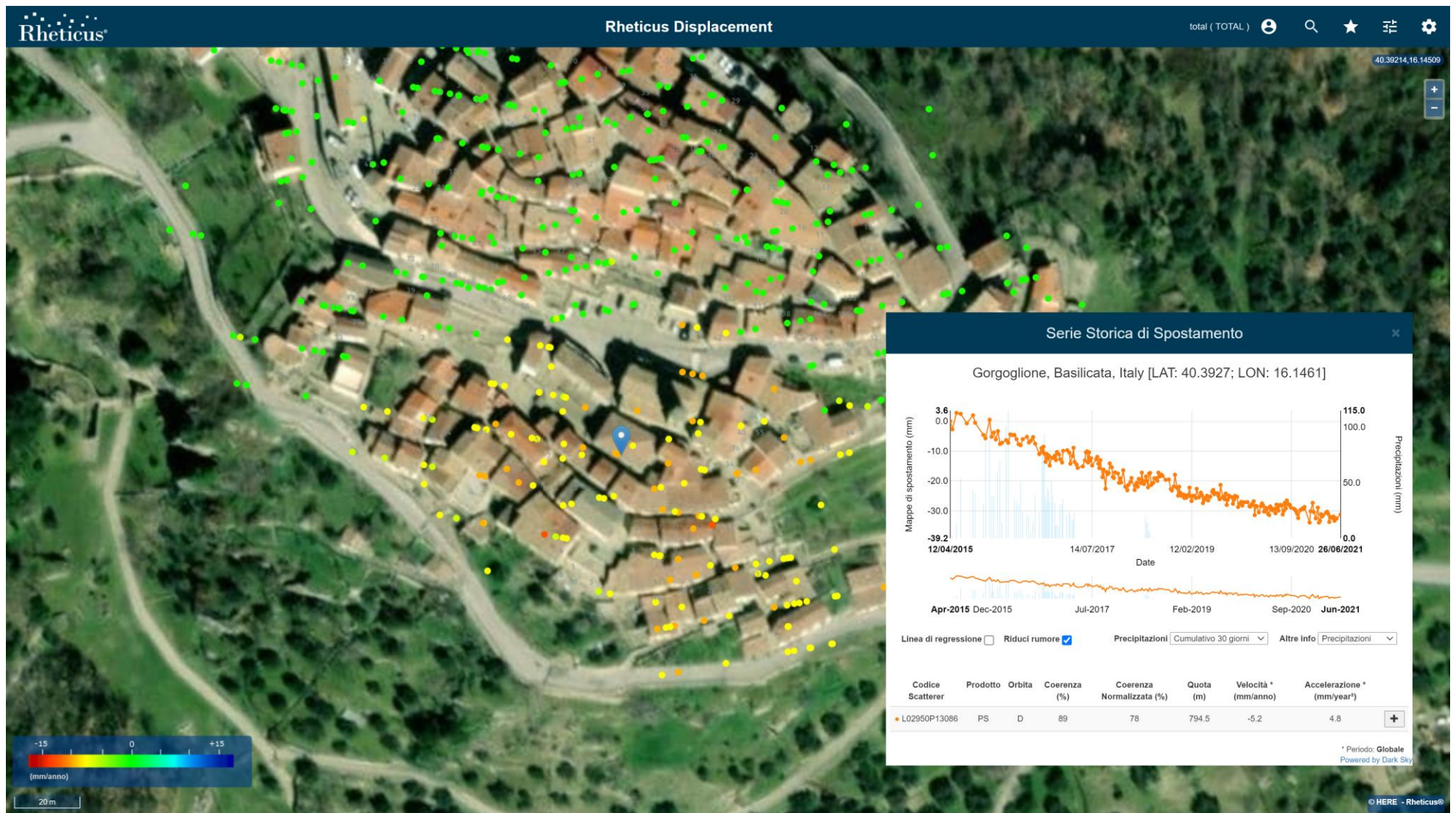
Figura 8: Serie temporale del PS (evidenziato dal puntatore blu nell'immagine) ad alta coerenza (0.89) situato al centro dell'area in movimento del centro abitato di Gorgoglione . La velocità media del PS sul periodo esteso a Giugno 2021 è pari a -5.2 mm/anno in linea con quanto misurato nel precedente rapporto [RD10].
