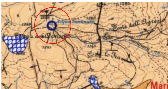
**Figura 8: Emergenza idrica per affioramento della piezometrica in zona di profonda incisione valliva**
