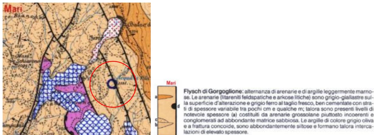
**Figura 9: Emergenza idrica in corrispondenza di un lineamento di faglia all'interno della Formazione Gorgoglione**
