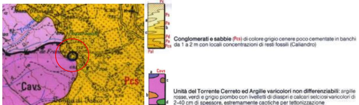
**Figura 5: Emergenza idrica al contatto tra unità geologiche a differente litologia e grado di permeabilità relativa**
