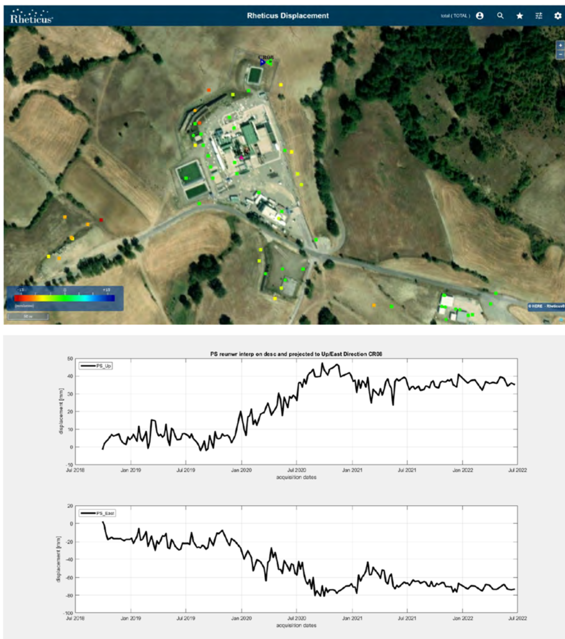
Figura 12: Velocità media PS e grafici di spostamento del corner reflector CR08 (Pozzo GG2)
