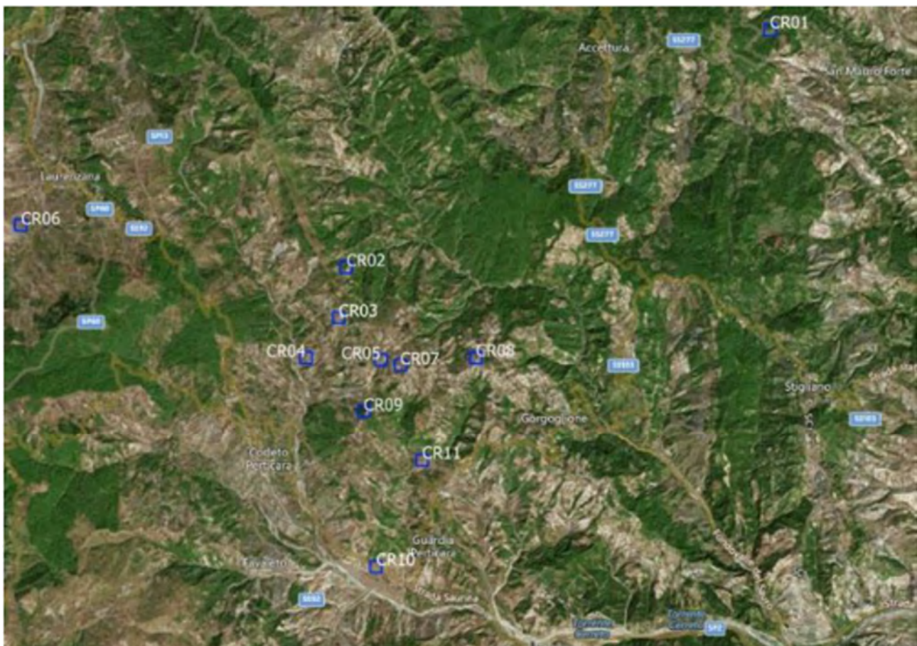
Figura 3: Mappa di distribuzione degli 11 Corner Reflector installati per il monitoraggio della subsidenza
