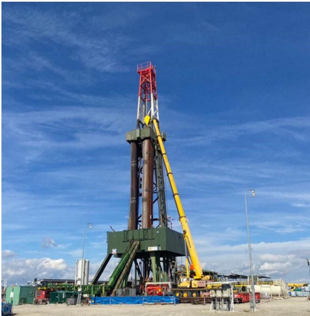
Figura 14: Immagine esemplificativa della torre di perforazione utilizzata durante la fase mineraria del progetto. Fonte: TotalEnergies
