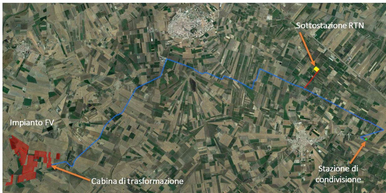
Figura 4 - Elementi principali della linea di connessione
