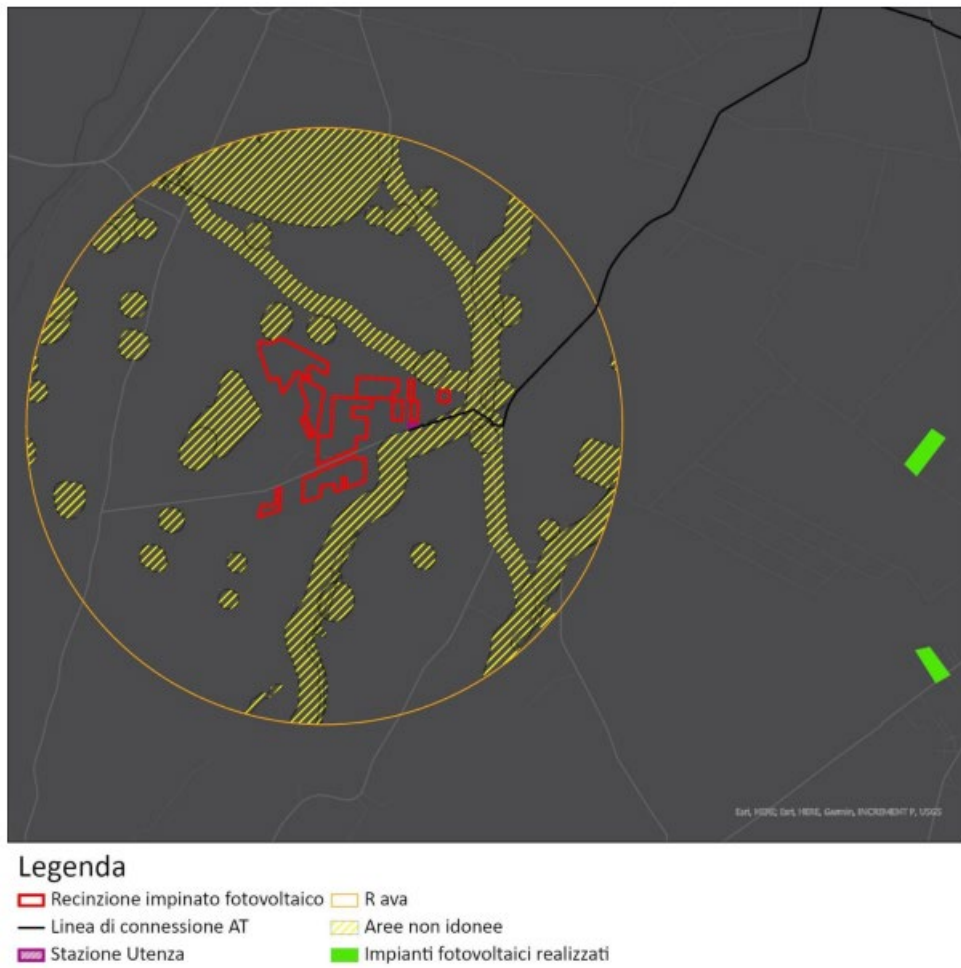
Figura 6 - Stato dei luoghi rispetto alla presenza di FER: a) assenza impianti fotovoltaici (Fonte: SIA)
