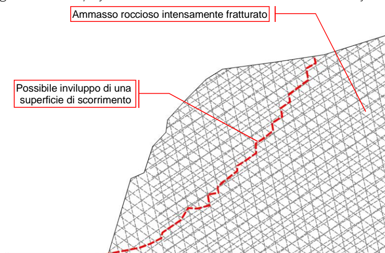
Figura 11.8 – Superficie di scorrimento in un ammasso estremamente fratturato
