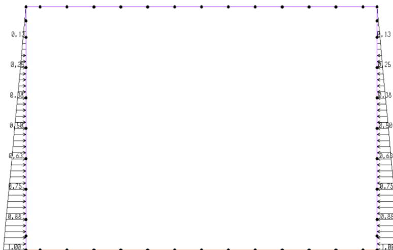
FIGURA 8 – CARICO SPINTA LATERALE STATICA TERRE
