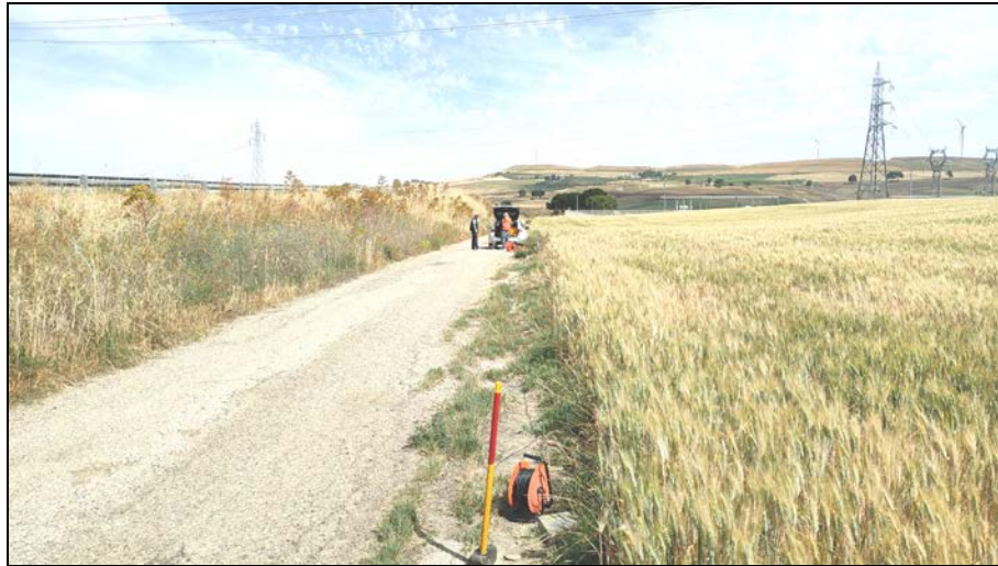
Fig.17 - Esecuzione indagine MASW (scoppio lato Sud Est)
