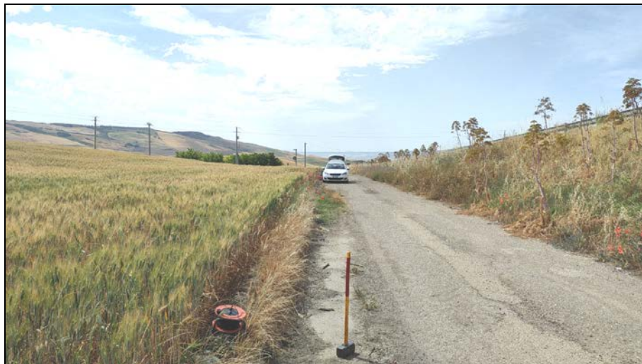
Fig.18 - Esecuzione indagine MASW (scoppio lato Nord Ovest).
