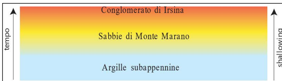
Figura 8 - Schema dei rapporti stratigrafici dei depositi quaternari marini della Fossa Bradanica secondo Carta Geologica d'Italia in scala 1:100.000.
