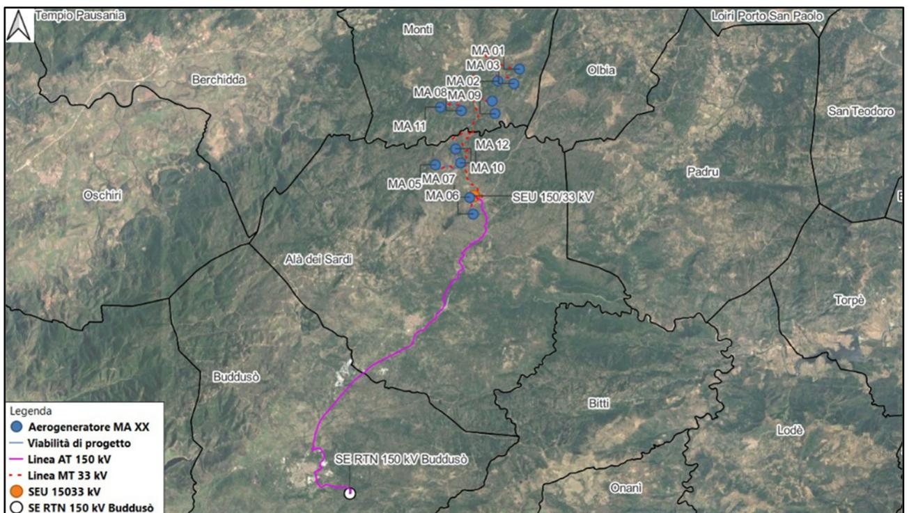
**Figura 2.3:** Layout dell'impianto eolico con aerogeneratori, SEU 150/33 Kv e SE RTN 150 kV su Ortofoto
