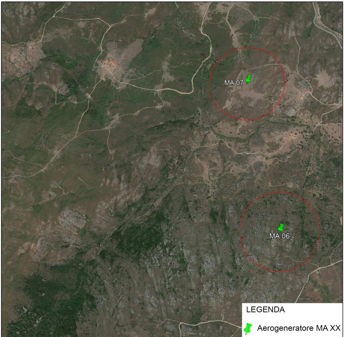
**Figura 9.4:** Aree interessate dalla rottura della pala relativamente agli aerogeneratori MA 06 e MA 07 su immagine satellitare
