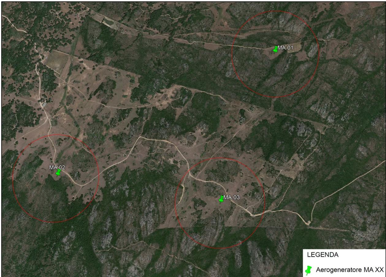
**Figura 9.1:** Aree interessate dalla rottura della pala relativamente agli aerogeneratori MA 01, MA 02 MA 03 su immagine satellitare
