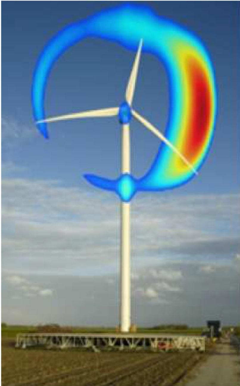
Rumore rilevato con SISTEMA BEAMFORMING
