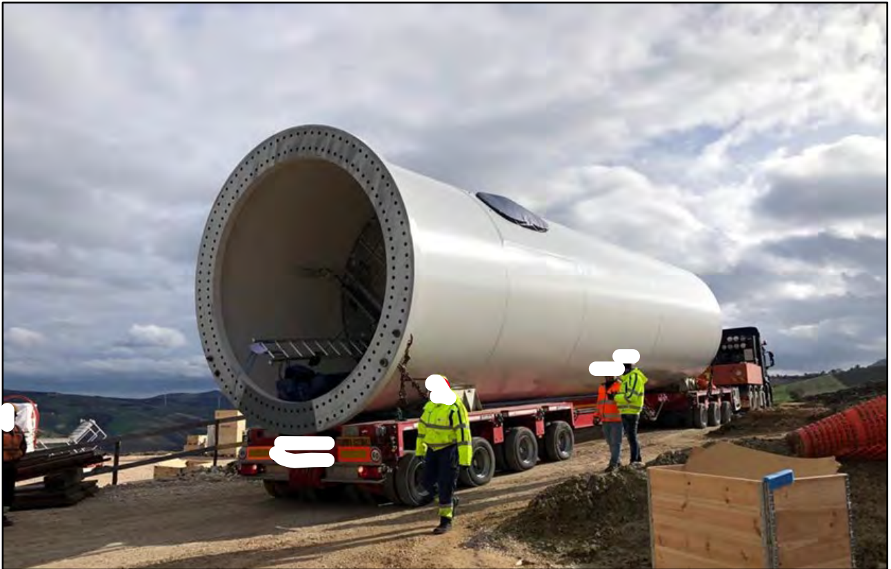
Figura 3.3: Mezzo speciale trasporto componenti WTG
