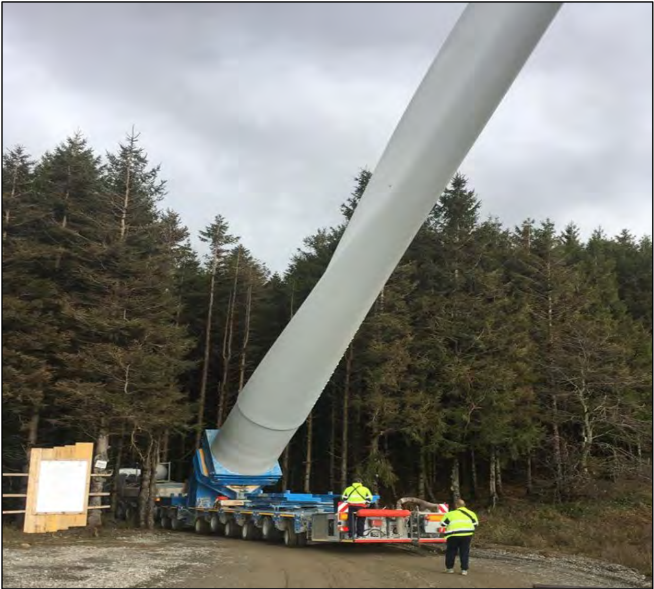
Figura 4.3: Trasporto con “Blade Lifter”
