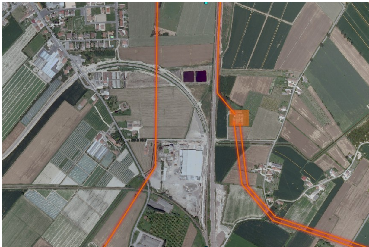
Illustrazione 20: Linee elettriche AT e cabina primaria
