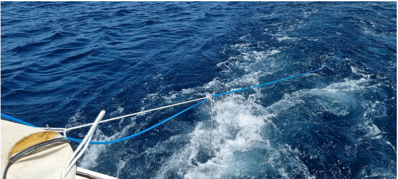
Figura 12: Prospezioni del fondale marino tramite Side Scan Sonar. Il veicolo sottomarino detto “pesce” viene trainato sott’acqua dall’imbarcazione
