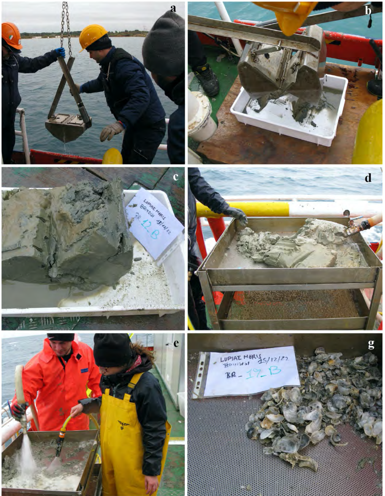
Fig. 5.1.1.C – Fasi del campionamento del sedimento e del macrobenthos. a) salpaggio della benna van Veen a bordo dopo aver prelevato il sedimento; b) svuotamento del contenuto della benna in vasconi di plastica; c) etichettatura del campione e realizzazione di una fotografia; d) svuotamento del sedimento su tavolo a setacci multipli utilizzato per la cernita ed il prelievo degli organismi bentonici; e) fase di setacciatura del sedimento al fine di selezionare gli organismi viventi all'interno; f) risultato della setacciatura di un campione.
