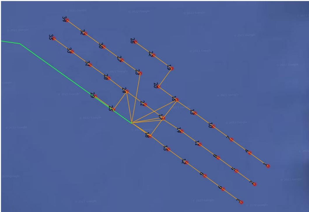
**Figura 8.2:** cavi di collegamento tra aerogeneratori e sottostazione offshore
