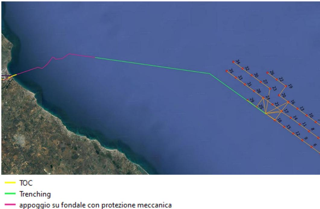
Figura 8.4: tipologie di posa del cavo offshore
