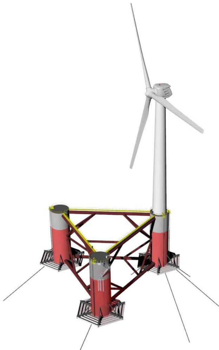
*Figura 2.3: Configurazione semisommersibile tipo Windfloat da 2MW [3] La configurazione semisommersibile da 15MW proposta in questa relazione si basa su questa e su configurazioni similari di maggiori dimensioni (confronta il paragrafo 2.2.1)*
