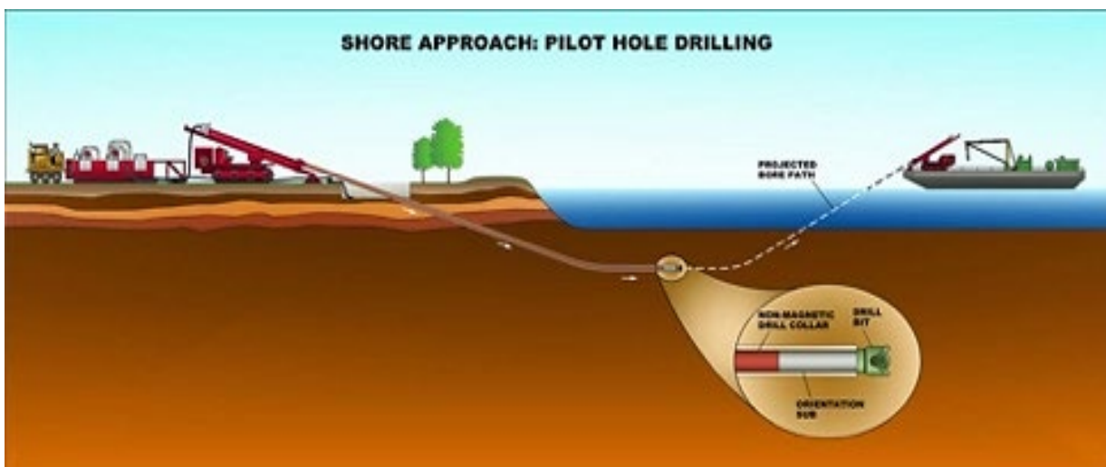
Schema trivellazione orizzontale controllata
