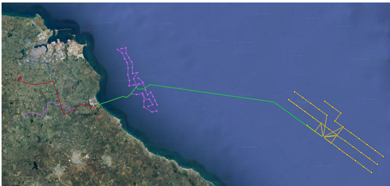
Percorso elettrodotto di connessione con impianti eolici Lupiae Maris e TG Energie Rinnovabili
