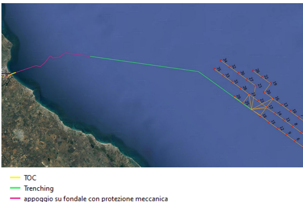
Figura 5.6: tipologie di posa del cavo offshore
