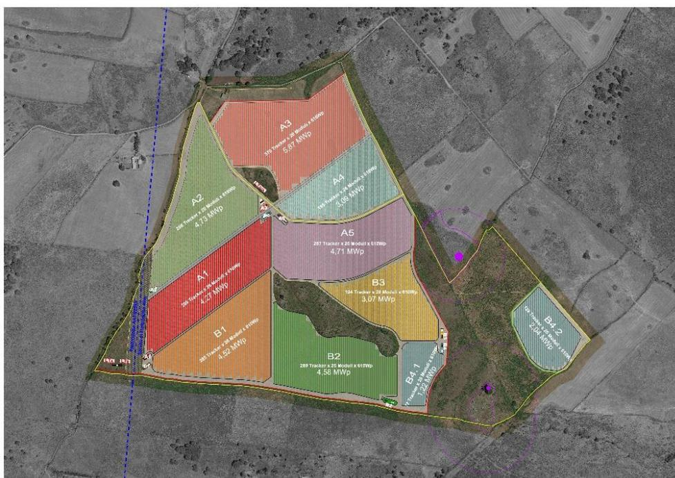
A lato l'assetto della centrale FV; a ciascun colore corrisponde un campo FV indipendente, collegato ad un proprio inverter (inverter centralizzati Outdoor).
