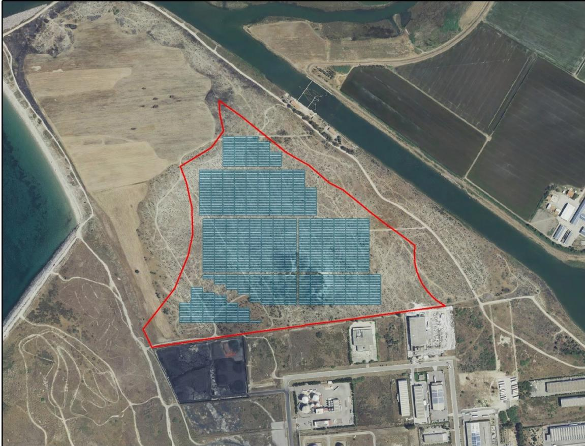
Figura 1 – Planimetria su ortofoto dell'impianto fotovoltaico e delle opere di connessione
