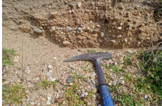
Foto 10 - Particolare di depositi alluvionali, sabbioso-ghiaiosi.
