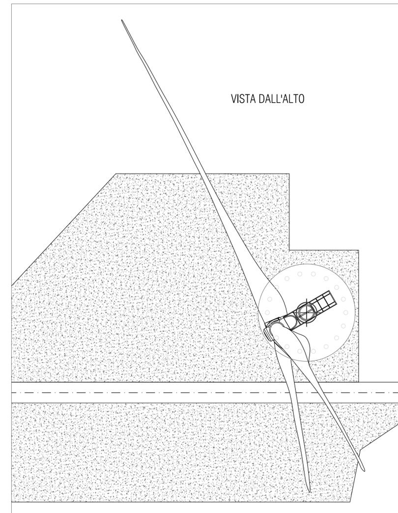
Nota: Le dimensioni riportate sono relative ad un modello generico di turbina di grande taglia. In base al modello di aerogeneratore selezionato in fase esecutiva, tali dimensioni potranno variare rispettando comunque l'altezza complessiva massima di 220 m (diametro del rotore, massimo 170 m; altezza al mozzo, massimo 135 m).
