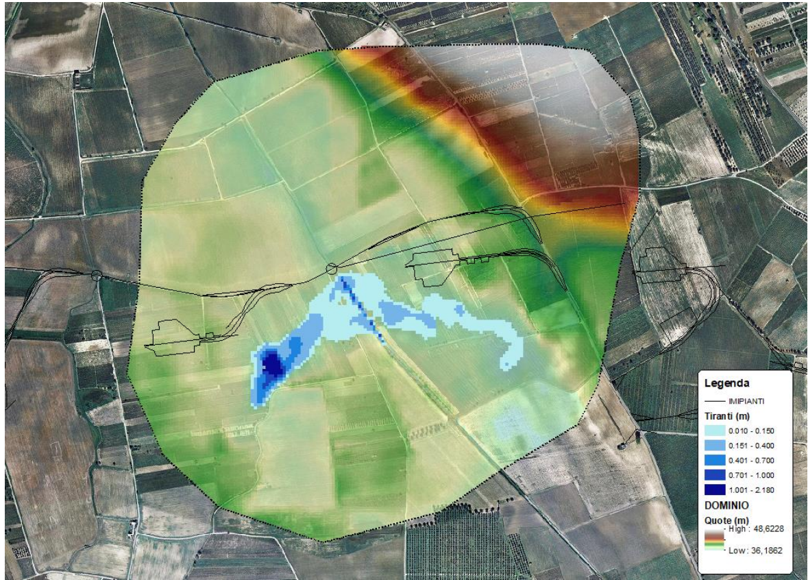
Figura 29 – Aree inondabili con indicazione del tirante massimo per ogni cella (tempo di ritorno 30 anni).
