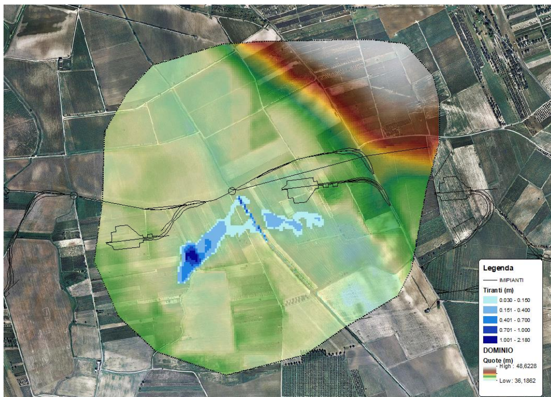
Figura 38 – Aree inondabili durante la progressione dell'onda di piena (tempo di ritorno 30 anni – t = 4 ore).
