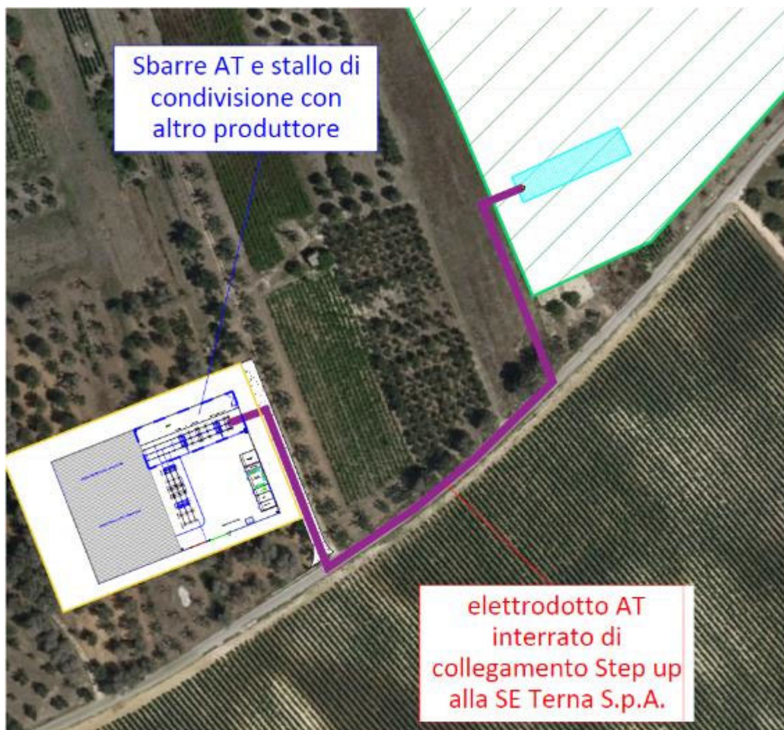
Figura 90 - Planimetria sulle opere di connessione alla RTN su base ortofoto
