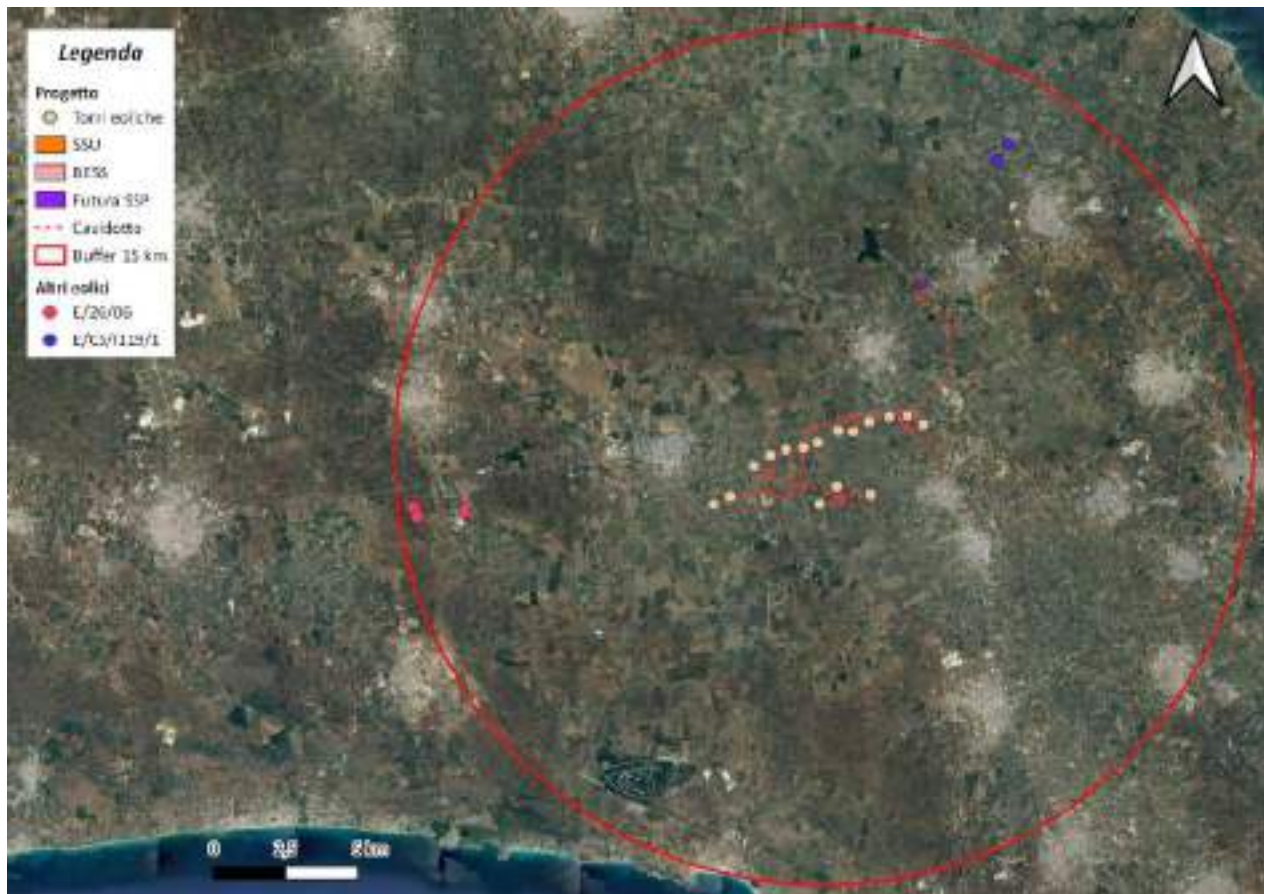
Figura 210: Impianti individuati nell'area buffer 15 km (poligono rosso) intorno al proposto parco eolico
