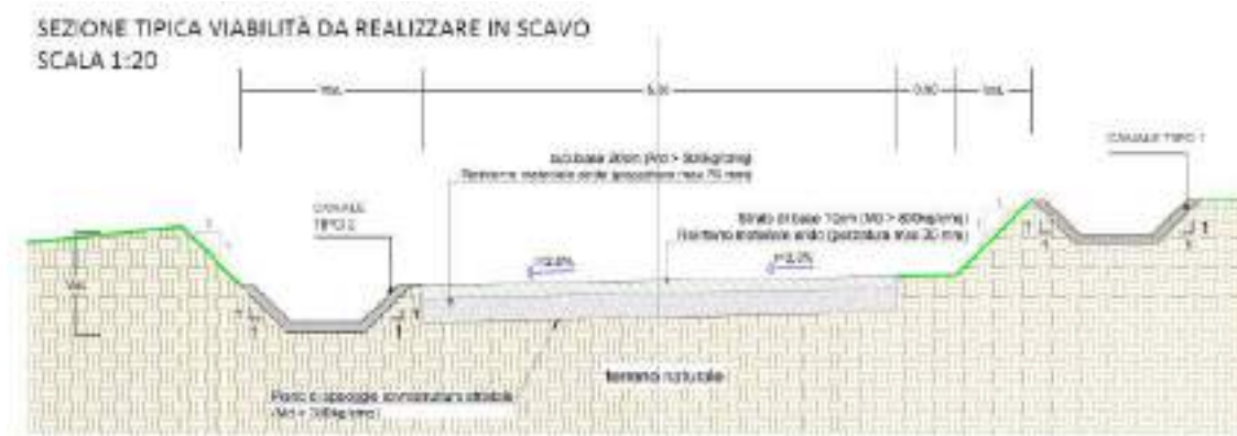
Figura 156: Sezione stradale tipo in scavo
