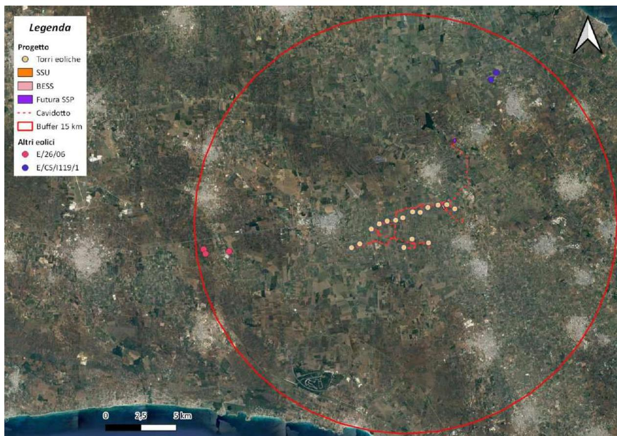
**Figura 91: Impianti individuati nell'area buffer 15 km (poligono rosso) intorno al proposto parco eolico**
