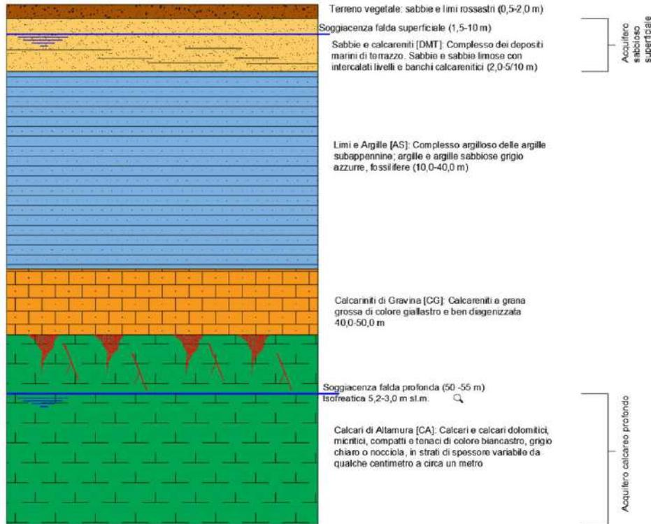
Figura 41: Assetto stratigrafico dell'area del parco eolico
