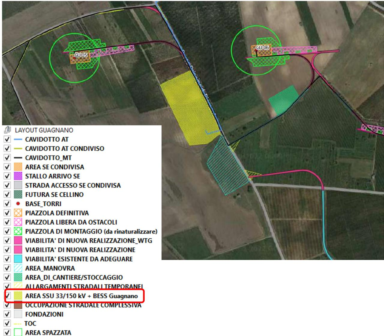
**Figura 14: Schema su ortofoto del collegamento tra torri, sottostazione utente (SSU) e sistema di accumulo (BESS)**
