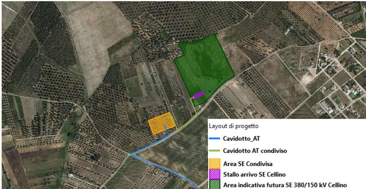
**Figura 15: Schema su ortofoto del collegamento alla rete elettrica nazionale di distribuzione**
