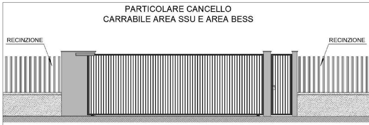
**Figura 44 – Tipologico - Accesso carrabile Aree BESS e SSU**
