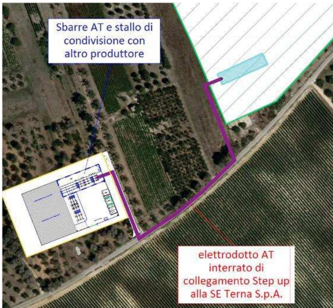
**Figura 46: Individuazione su ortofoto dell'impianto di utenza per la connessione**
