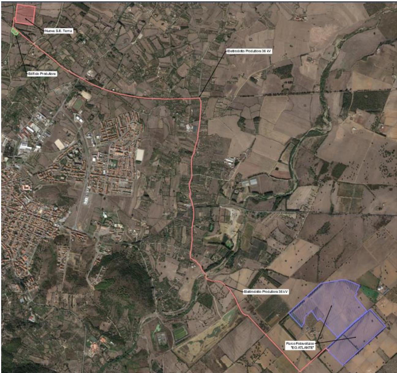
*Figura 4 - Inquadramento su ortofoto Impianto FV EG ATLANTE e relative opere di connessione alla rete a 36kV*
