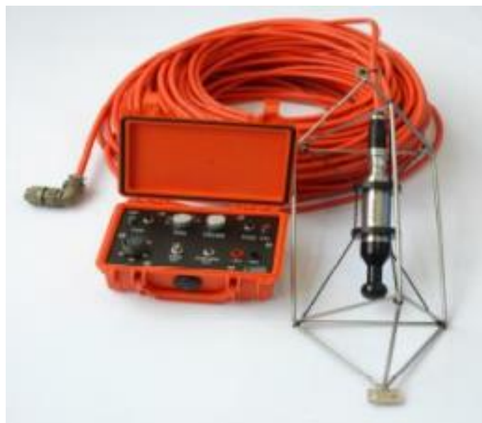
Figura 4. Registratore acustico COL.MAR con idrofono SMID DH200GP usato per misurare il rumore sottomarino presso l'FSRU Toscana.
