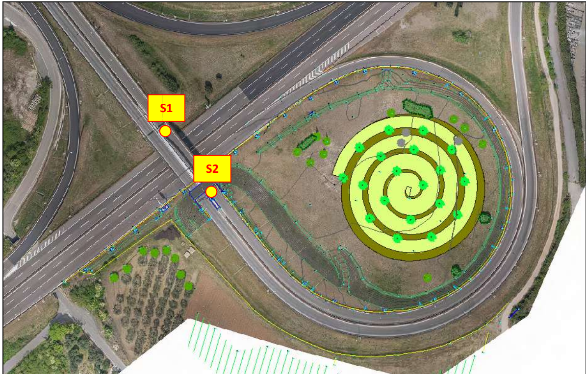
FIG. 15 - PLANIMETRIA SCHEMATICA DELL'INTERVENTO NELLO SVINCOLO DI AFFI CON UBICAZIONE DEI SONDAGGI
