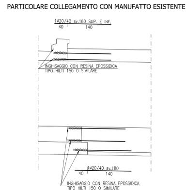
**TOMBINO A TELAIO CHIUSO L=2.00x2.00 m - CARPENTERIA STATO DI PROGETTO**
