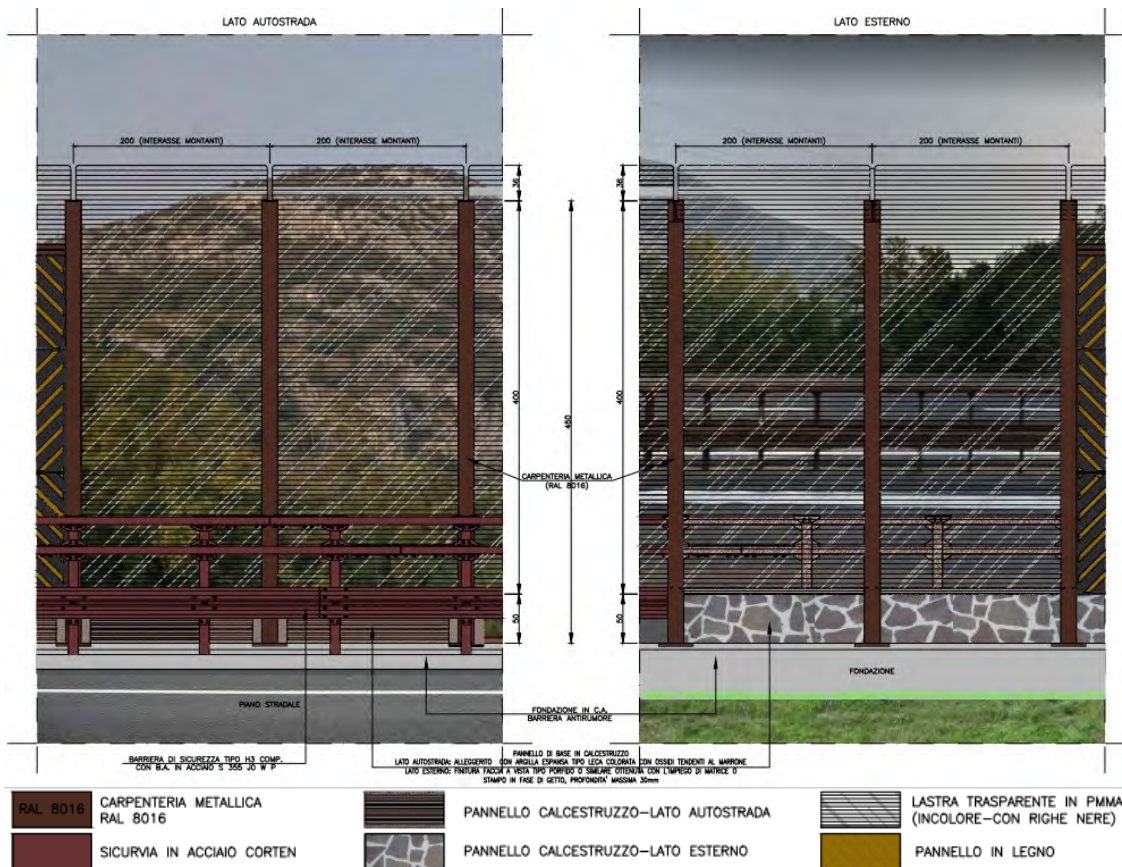
Figura 41: Analisi cromatica del tratto terminale Nord della barriera acustica in PMMA
