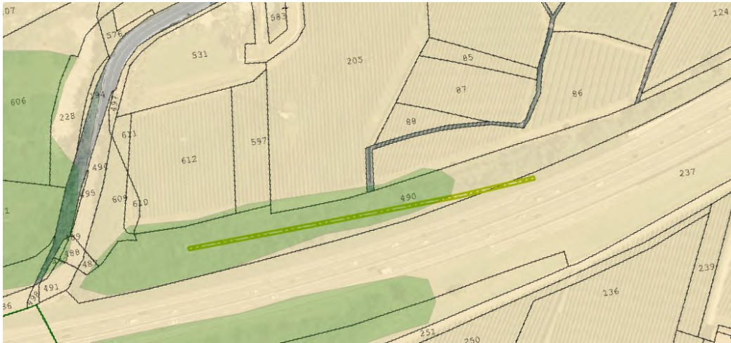
Figura 47: Localizzazione (campitura a pallini verdi) delle aree in cui è prevista la ripiantumazione a fine lavori in località Canale (Foglio 5, mappale 490p e 237 p) dopo la posa della tubazione. In verde "Foreste ad alto valore naturalistico" (Tav. 01a PTRC)
