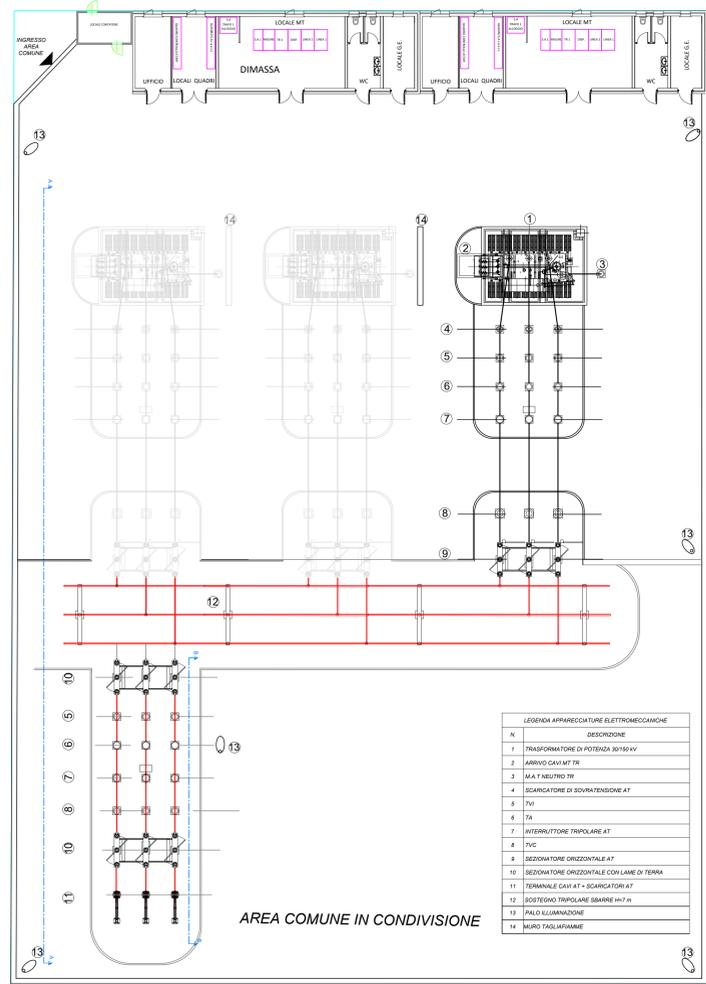
PLANIMETRIA DELLA SOTTOSTAZIONE DI TRASFORMAZIONE AT/MT - SCALA 1:200
