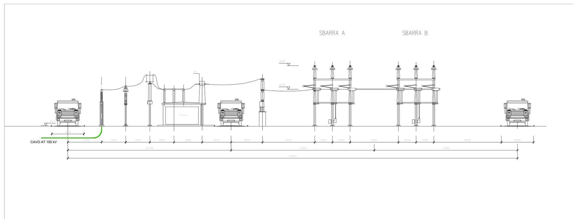
SEZIONE ELETTROMECCANICA DELLO STALLO A 150 kV DELLA STAZIONE ELETTRICA DI TROIA 380/150 kV - SCALA 1:100
