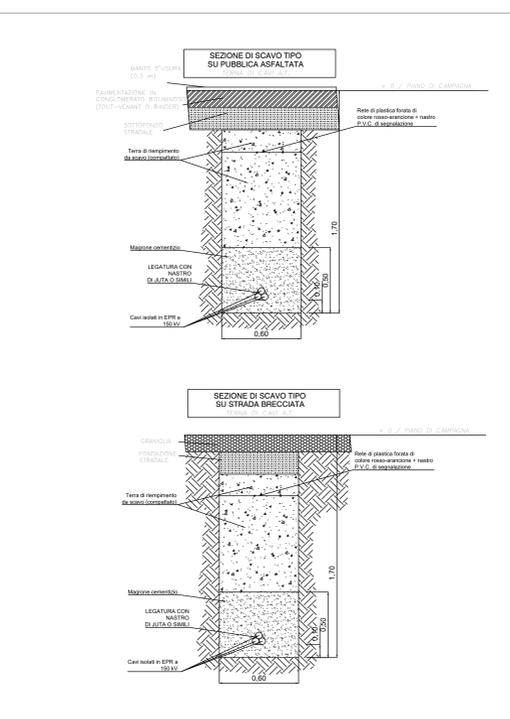
SEZIONE SCAVO TIPO PER CAVO AT - SCALA 1:20
