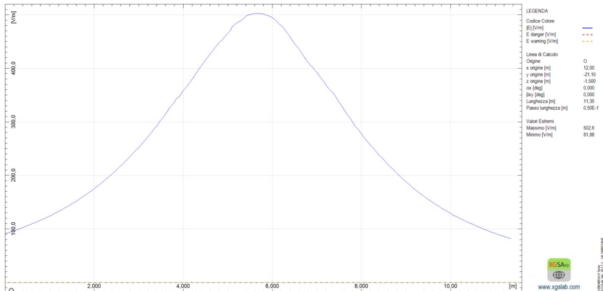
**Profilo del Campo Elettrico sulla sezione dei cavi di vettoriamento MT**
